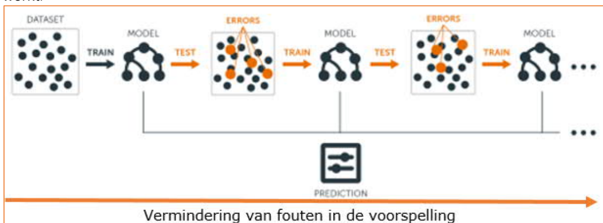
Figuur 3: schematische weergave van het proces van gradient boosting
