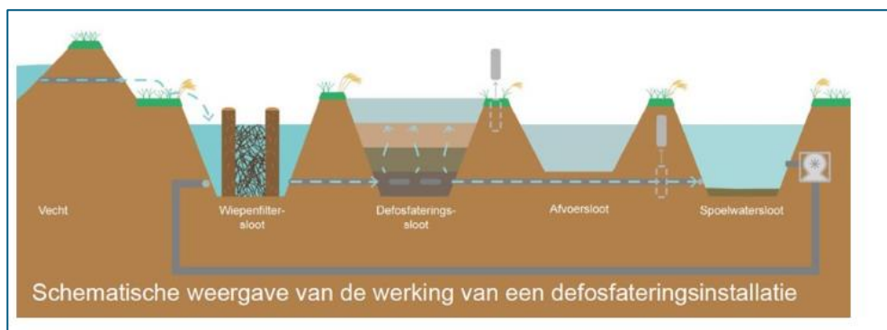
Figuur 3-4 Voorbeeld van een defosfateringsinstallatie in ontwikkeling bij Waternet ( https://www.waternet.nl/innovatie/schoon-water-defosfatering-oppervlaktewater ).
