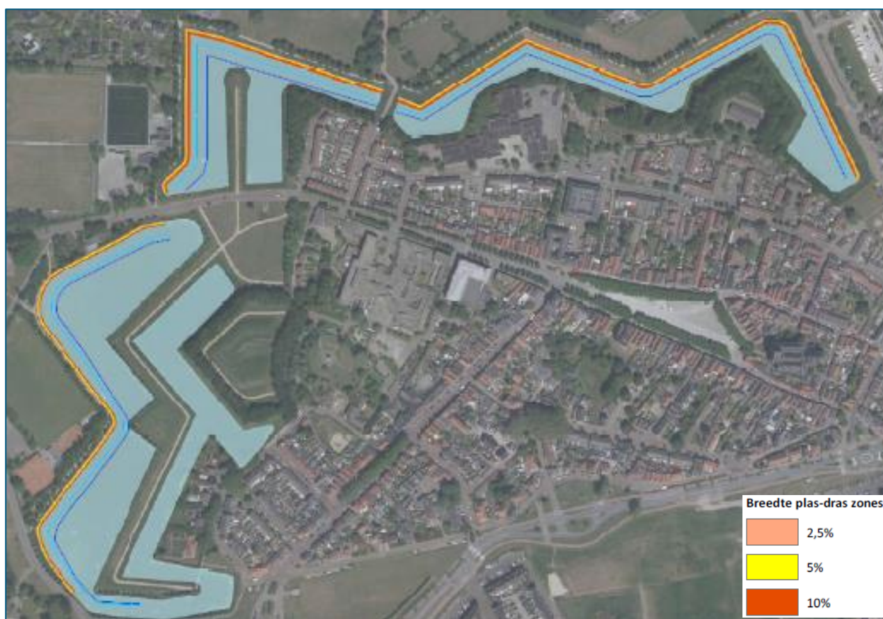
Figuur 2-6 Potentiele locatie voor de aanleg van een moeraszone en een indruk van de omvang van het areaal is ten opzichte van het wateroppervlak, uitgaande van een inrichting van 2,5%, 5% en 10% van het wateroppervlak. De lichtblauwe lijn geeft aan tot waar het talud komt in het water als een moeraszone wordt aangelegd van 10% met een helling van 1:3. De donkerblauwe lijn geeft aan tot waar het talud komt in het water als een moeraszone wordt aangelegd van 10% met een helling van 1:6.
