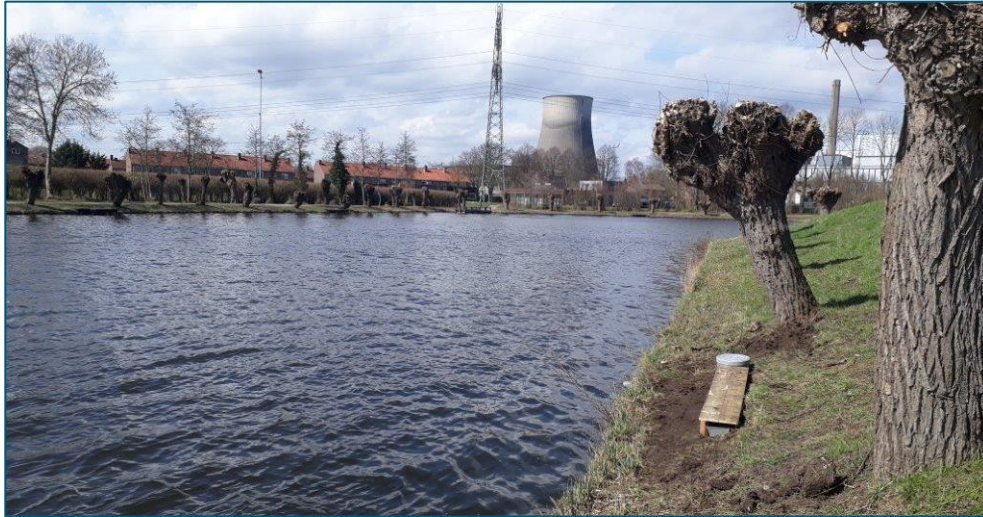
Figuur 1-12 meetgoot voor het onderzoek aan de kwaliteit van het water dat bij regen over het talud afstroomt naar De Veste.
