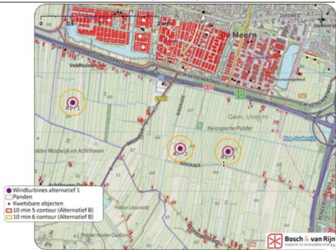
Figuur 3 Risicocontouren rond de windturbines (Alternatief 1B)
