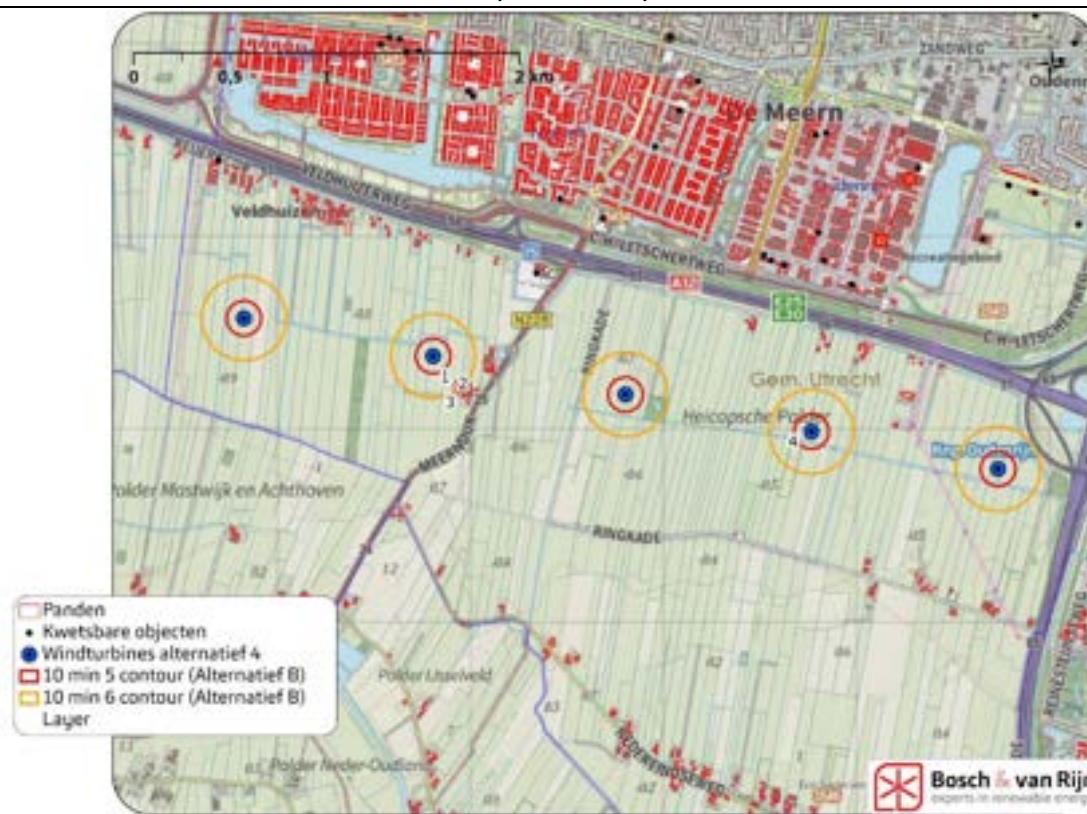
Figuur 9 Risicocontouren rond de windturbines (Alternatief 4B)
