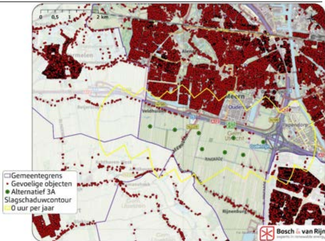
Figuur 41 0 uur slagschaduwcontour van alternatief 3A. Hierbij zijn ook de gevoelige objecten weergegeven.
