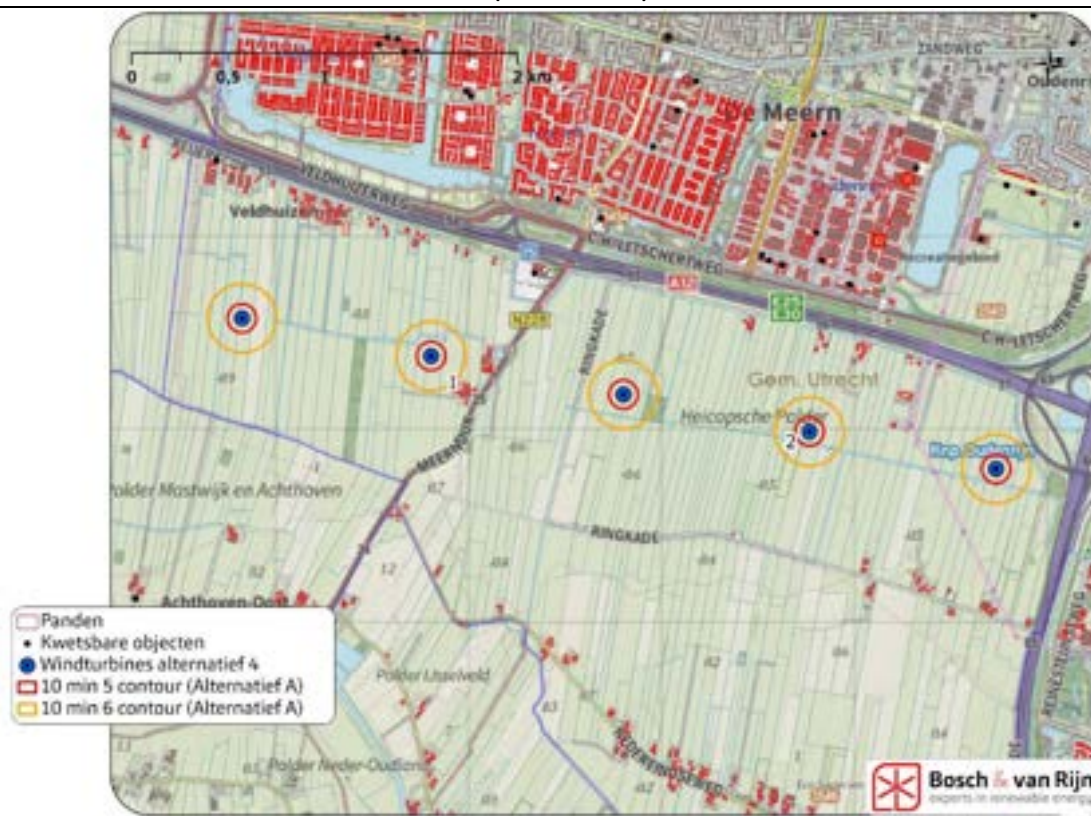
Figuur 8 Risicocontouren rond de windturbines (Alternatief 4A)
