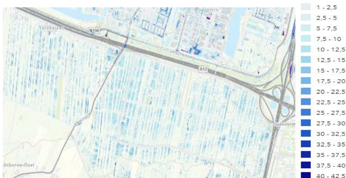
Figuur 35 Rekenresultaten water-over-straat berekening bij 80 mm blokbui
