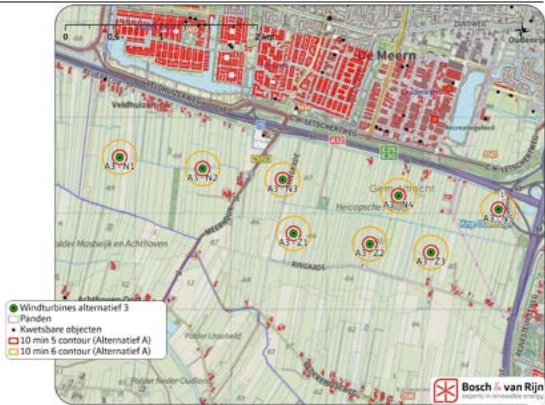
Figuur 6 Risicocontouren rond de windturbines (Alternatief 3A)
