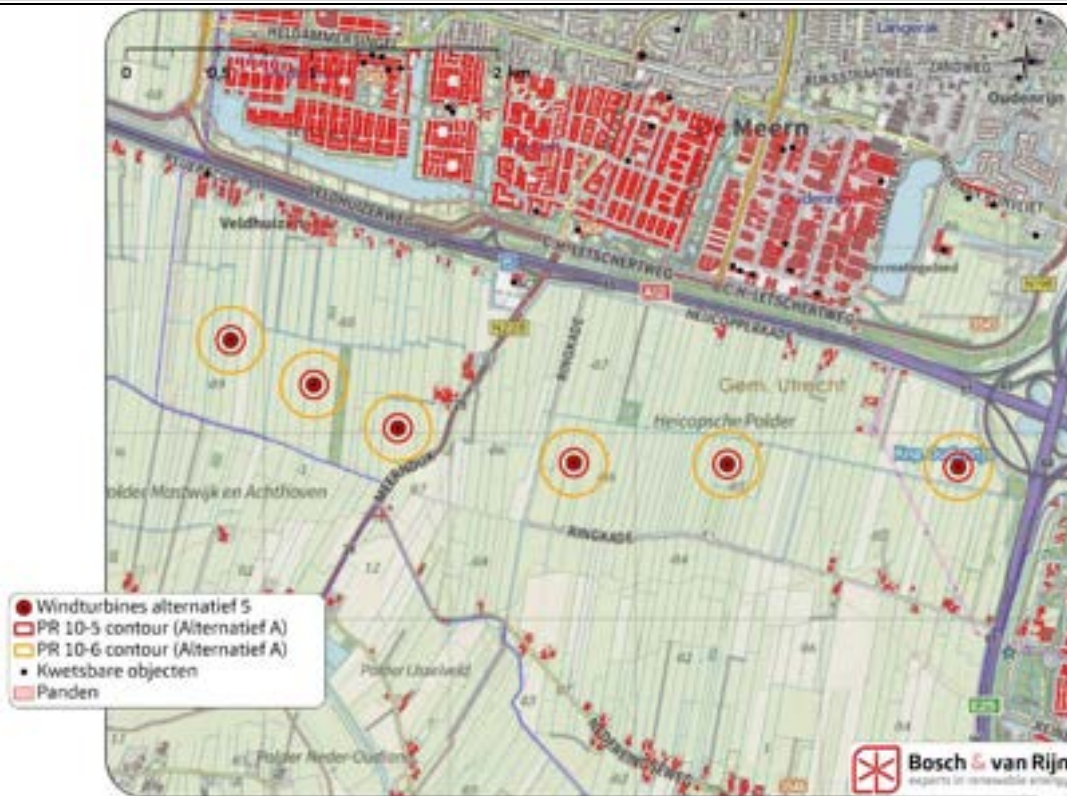
Figuur 10 Risicocontouren rond de windturbines (Alternatief 5A)
