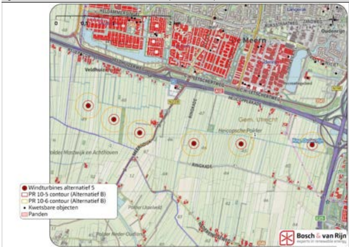
Figuur 11 Risicocontouren rond de windturbines (Alternatief 5B)
