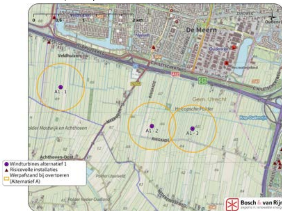
Figuur 12 Maximale werpafstand bij overtoeren van de windturbines en risicovolle installaties.
