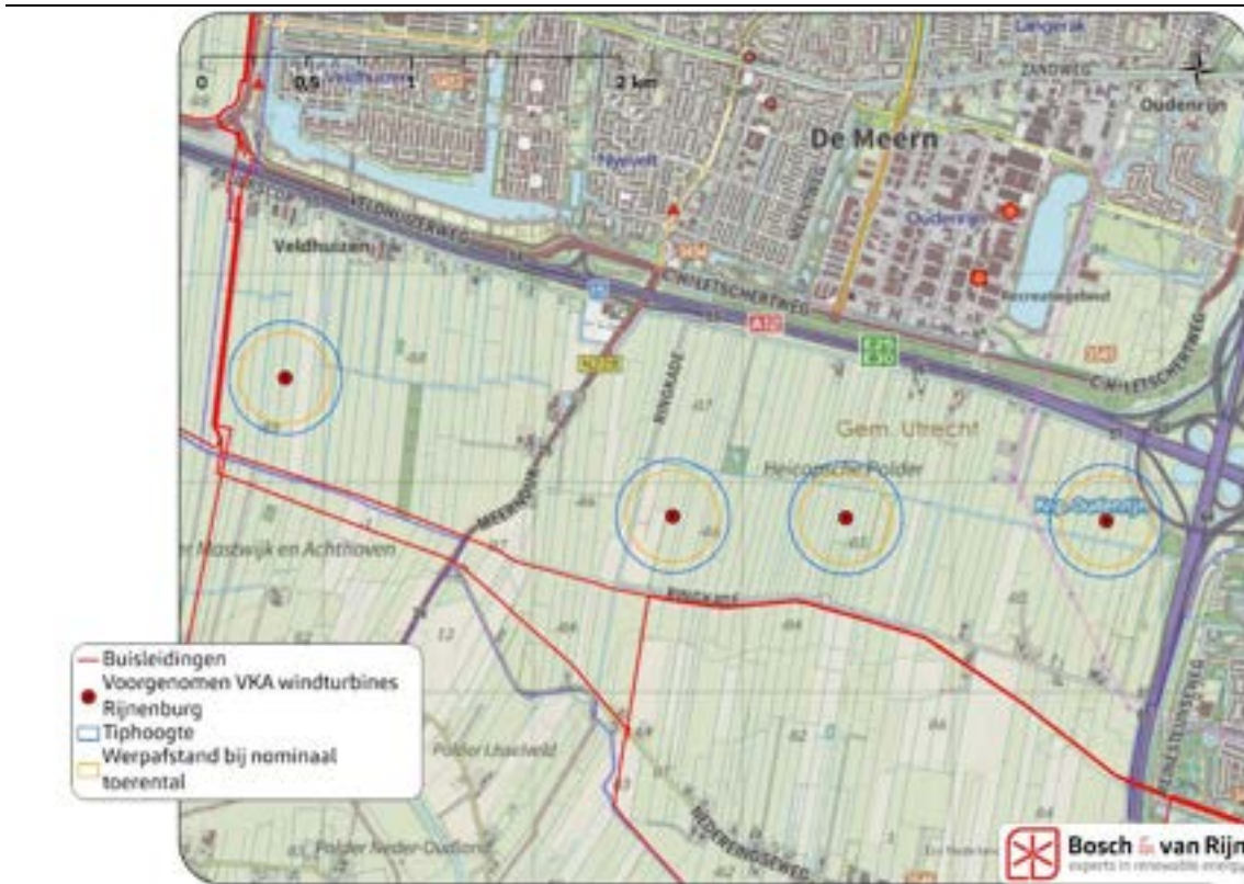
Figuur 63 Buisleidingen en adviesafstanden Gasunie
