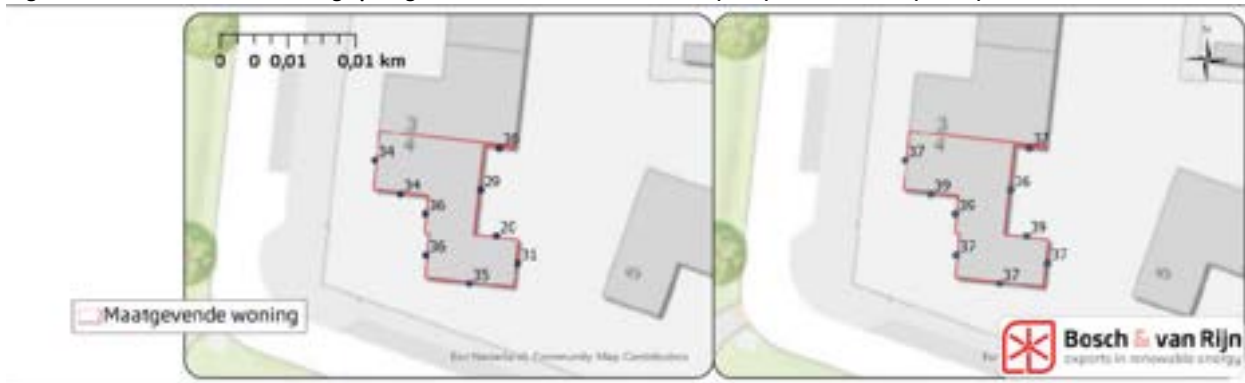
Figuur 50 Geluidsbelasting op de gevels in dB Lden van VKA onder (links) en VKA boven (rechts) - Aardaker 4 De Meern
