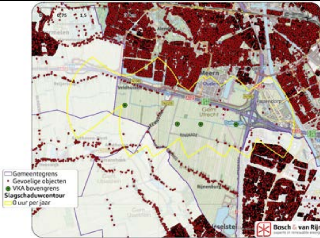
Figuur 21 0 uur slagschaduwcontour van de bovengrens van het voorkeursalternatief. Hierbij zijn ook de gevoelige objecten weergegeven.
