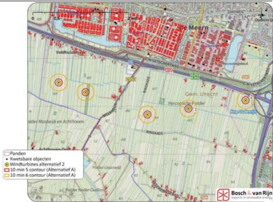
Figuur 4 Risicocontouren rond de windturbines (Alternatief 2A)
