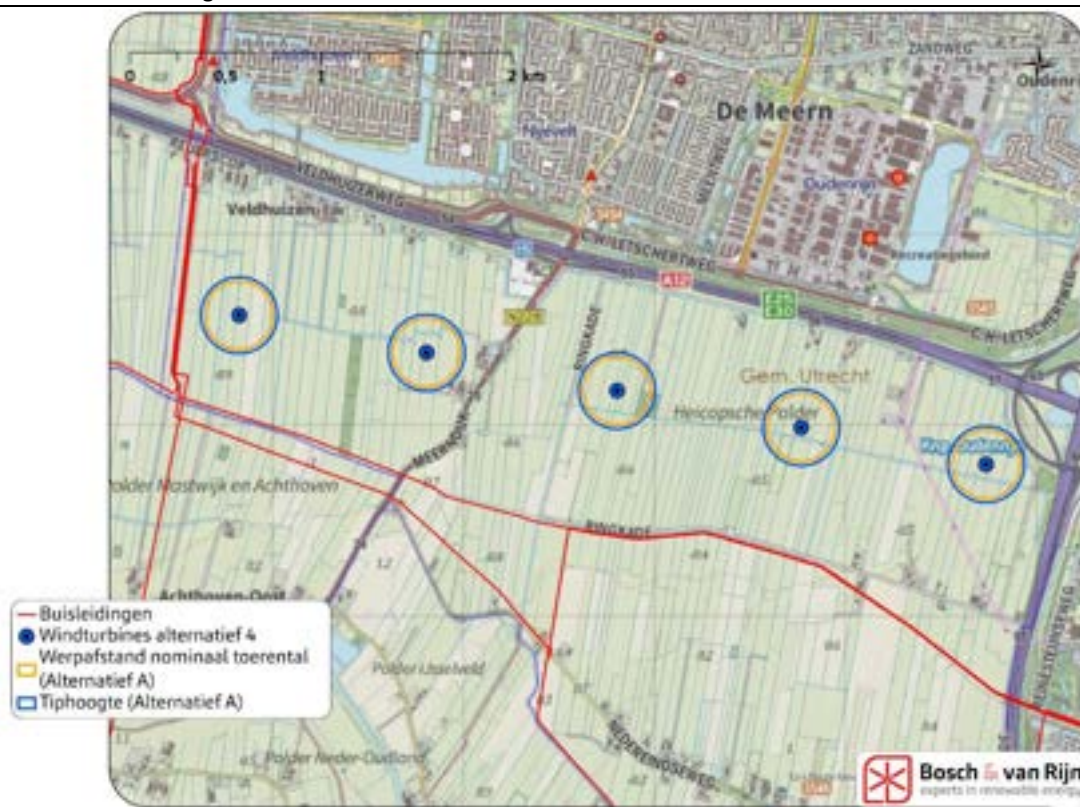
Figuur 28 Buisleidingen en adviesafstanden Gasunie
