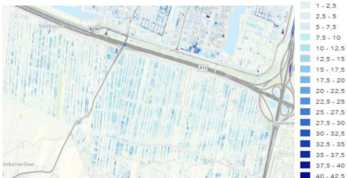
Figuur 9 Rekenresultaten water-over-straat berekening bij 80 mm blokbui.
