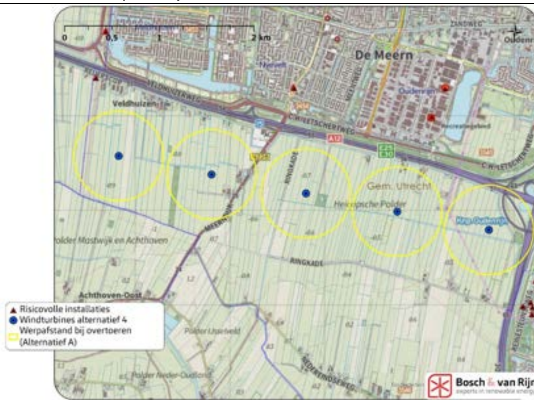
Figuur 18 Maximale werpafstand bij overtoeren van de windturbines en risicovolle installaties.
