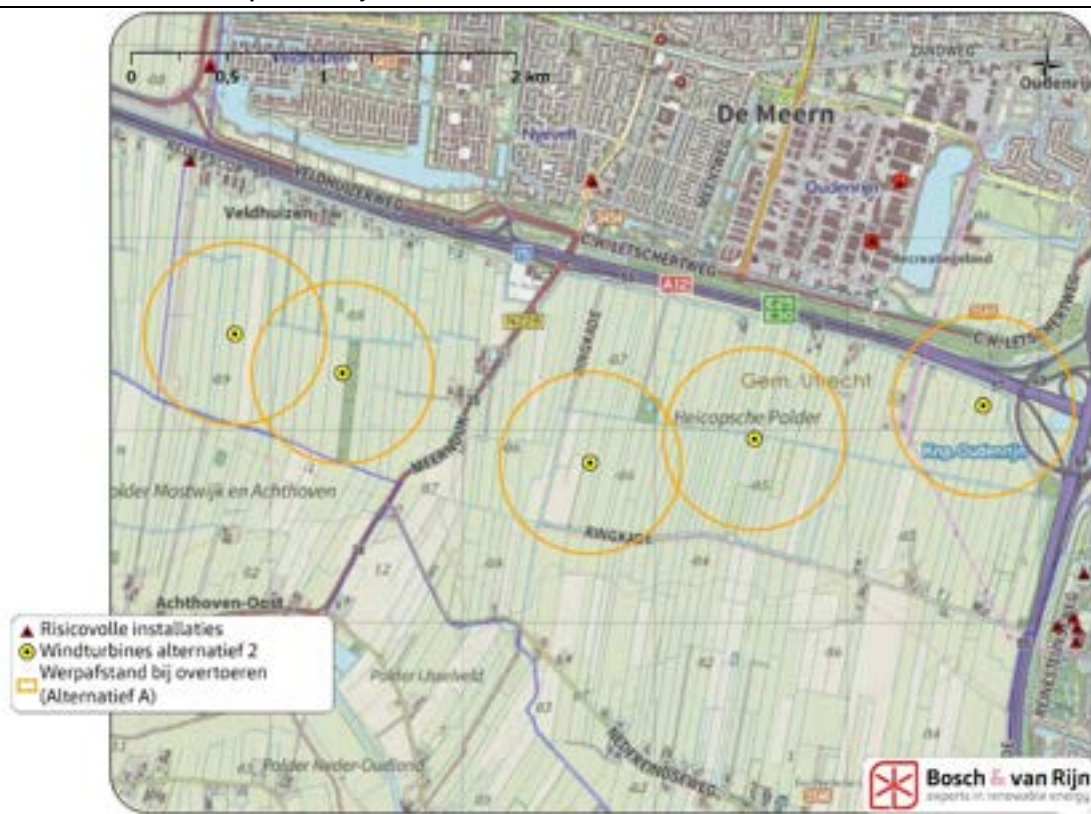
Figuur 14 Maximale werpafstand bij overtoeren van de windturbines en risicovolle installaties.
