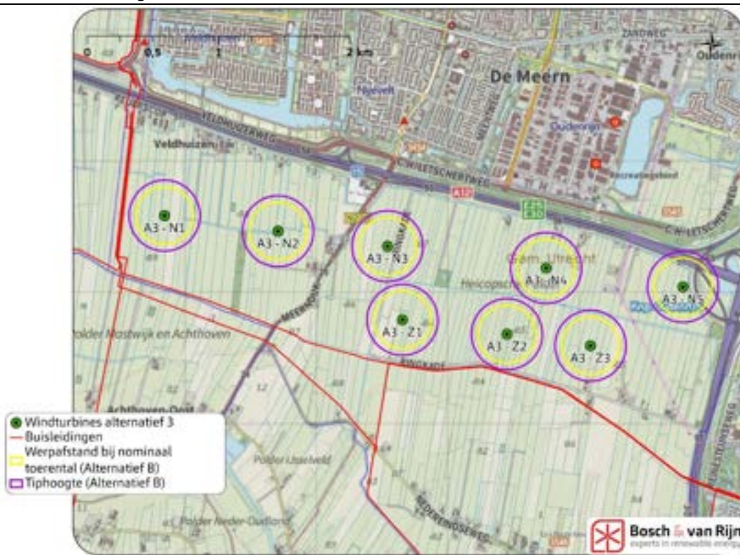
Figuur 27 Buisleidingen en adviesafstanden Gasunie
