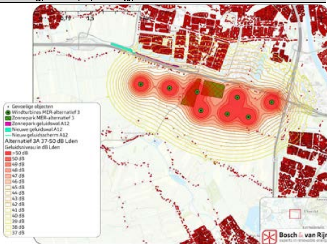
Figuur 93 Lden contouren (37 t/m 50 dB Lden) alternatief 3A
