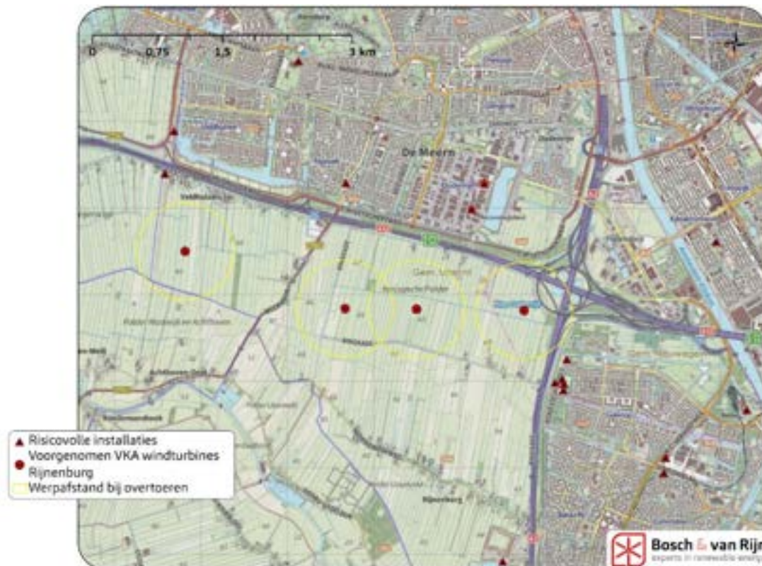
Figuur 25 Maximale werpafstand bij overtoeren van de windturbines en risicovolle installaties
