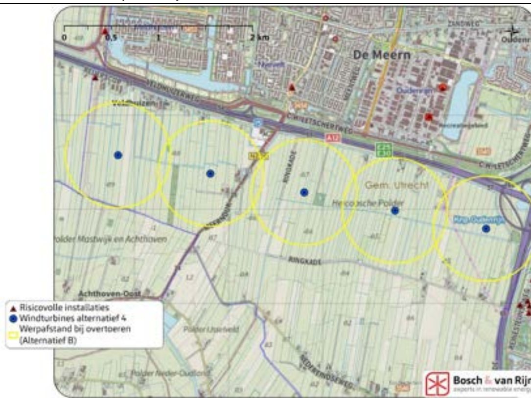
Figuur 19 Maximale werpafstand bij overtoeren van de windturbines en risicovolle installaties.
