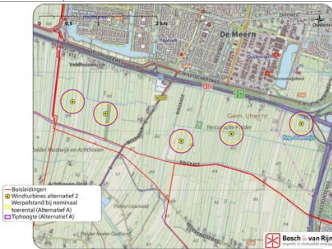
Figuur 24 Buisleidingen en adviesafstanden Gasunie
