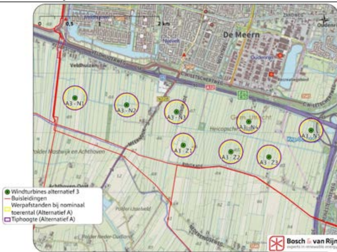
Figuur 26 Buisleidingen en adviesafstanden Gasunie
