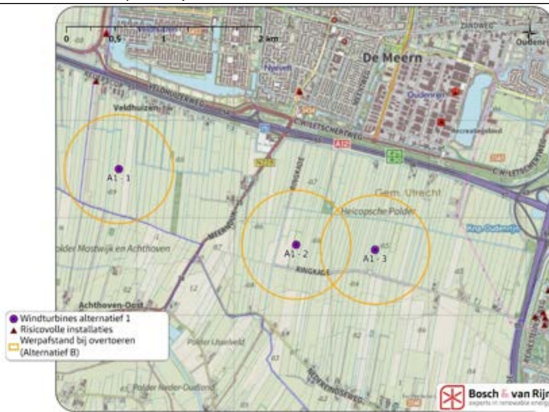
Figuur 13 Maximale werpafstand bij overtoeren van de windturbines en risicovolle installaties.
