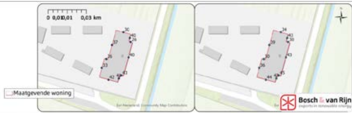
Figuur 55 Geluidsbelasting op de gevels in dB Lden van VKA onder (links) en VKA boven (rechts) - Heijcopperkade 2B Utrecht
