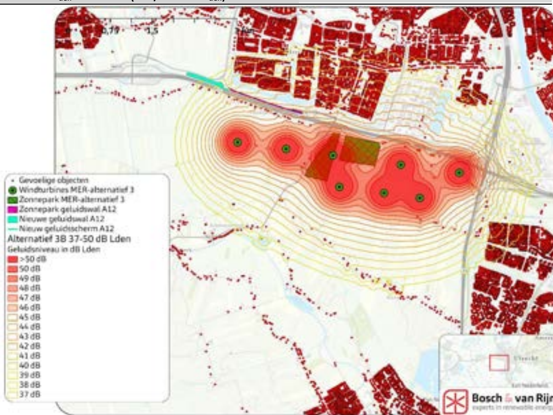
Figuur 94 L den contouren (37 t/m 50 dB L den ) alternatief 3B
