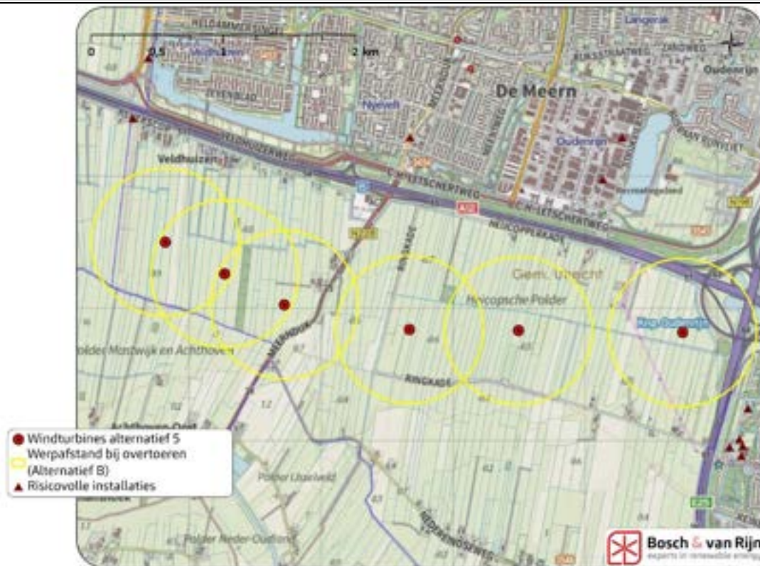
Figuur 21 Maximale werpafstand bij overtoeren van de windturbine en risicovolle installaties
