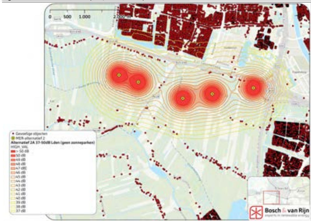
Figuur 12 Lden contouren (37 t/m 50 dB Lden) alternatief 2A
