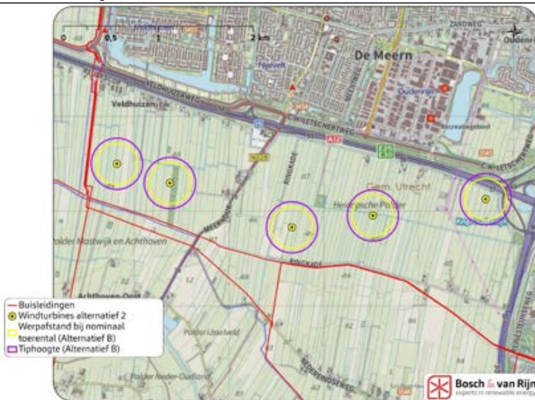
Figuur 25 Buisleidingen en adviesafstanden Gasunie
