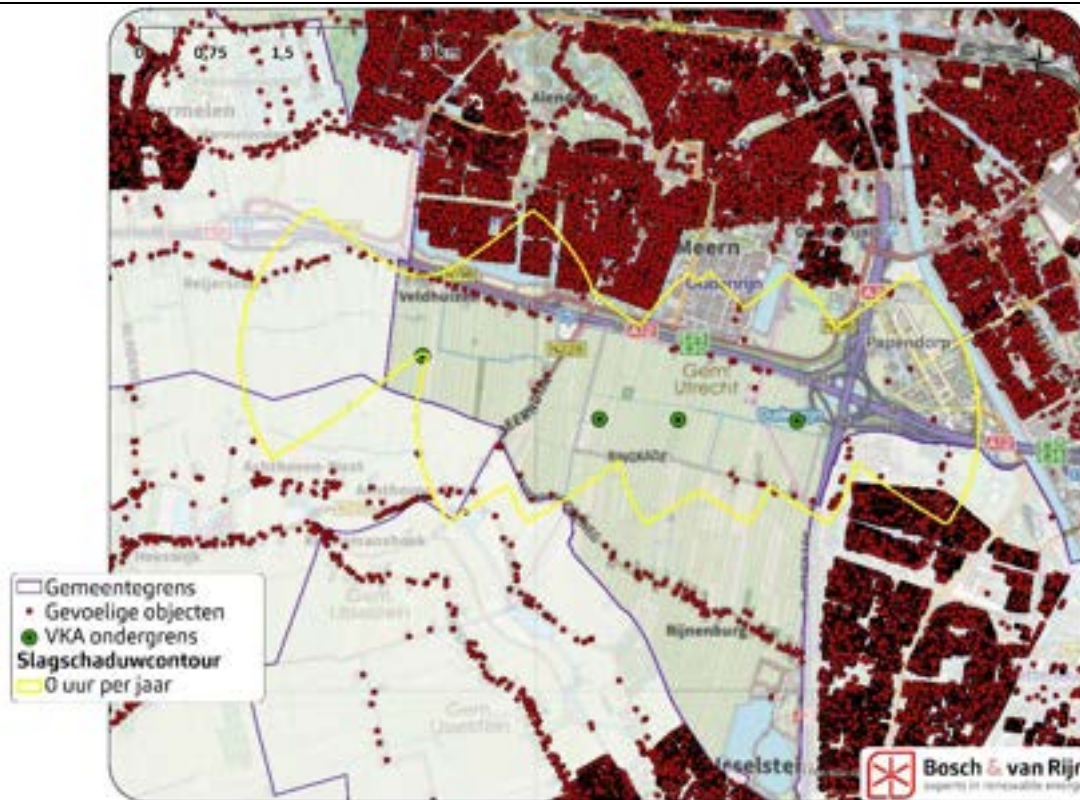
Figuur 20 0 uur slagschaduwcontour van de ondergrens van het voorkeursalternatief. Hierbij zijn ook de gevoelige objecten weergegeven.
