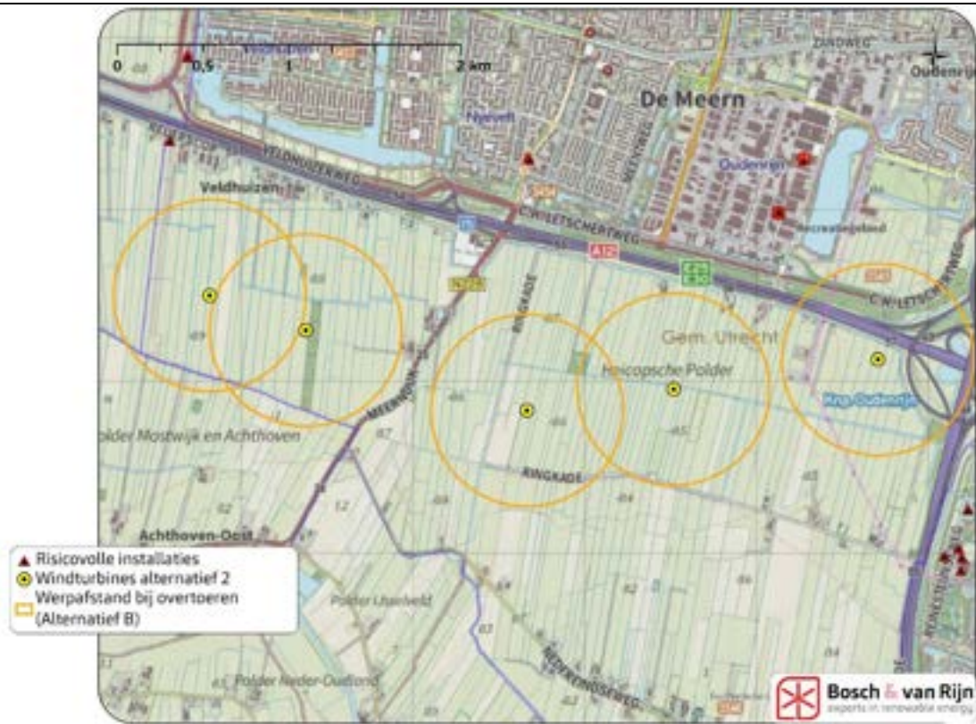
Figuur 15 Maximale werpafstand bij overtoeren van de windturbines en risicovolle installaties.
