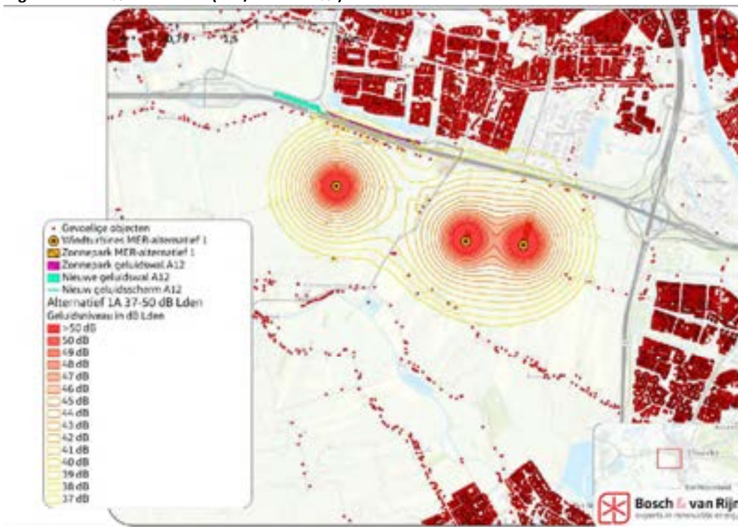
Figuur 21 Lden contouren (37 t/m 50 dB Lden) alternatief 1A
