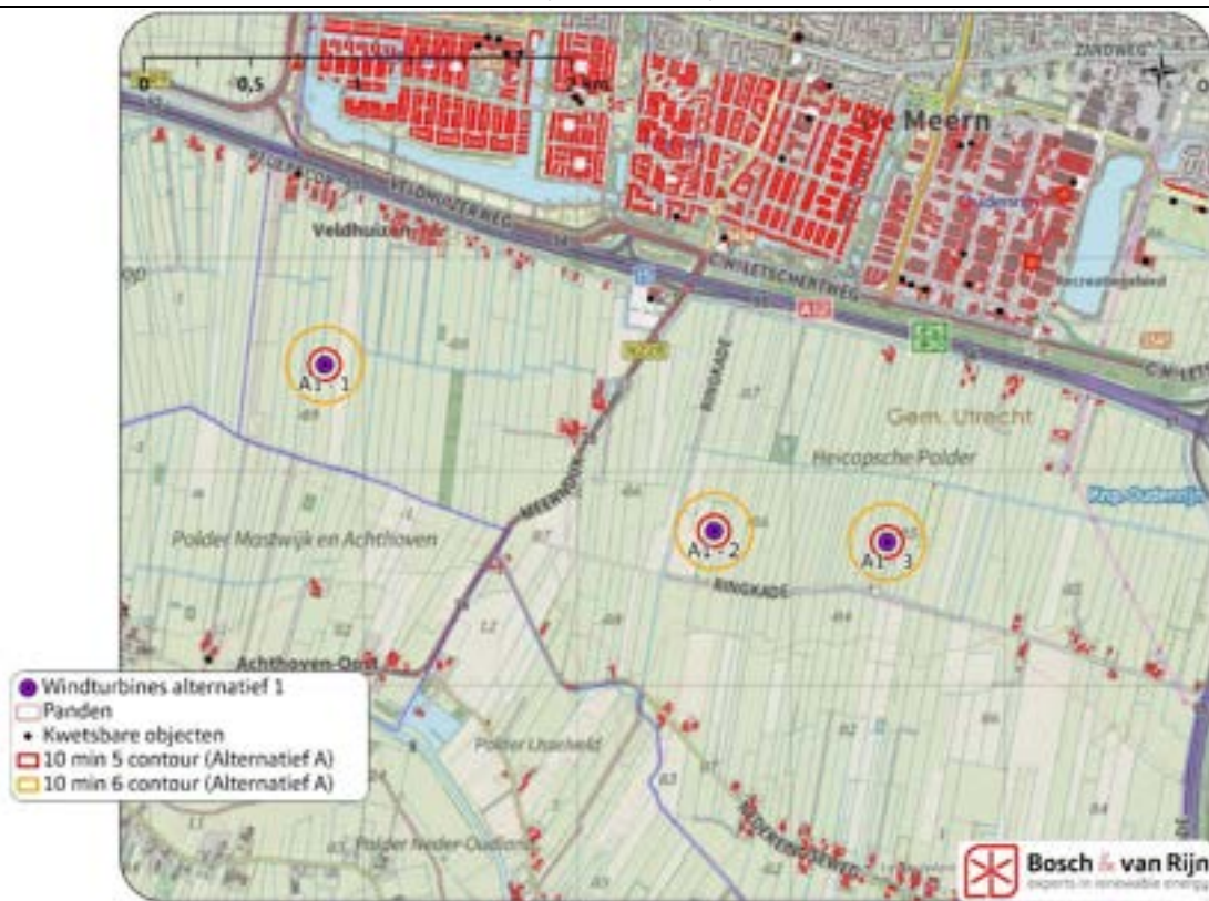
Figuur 2 Risicocontouren rond de windturbines (Alternatief 1A)
