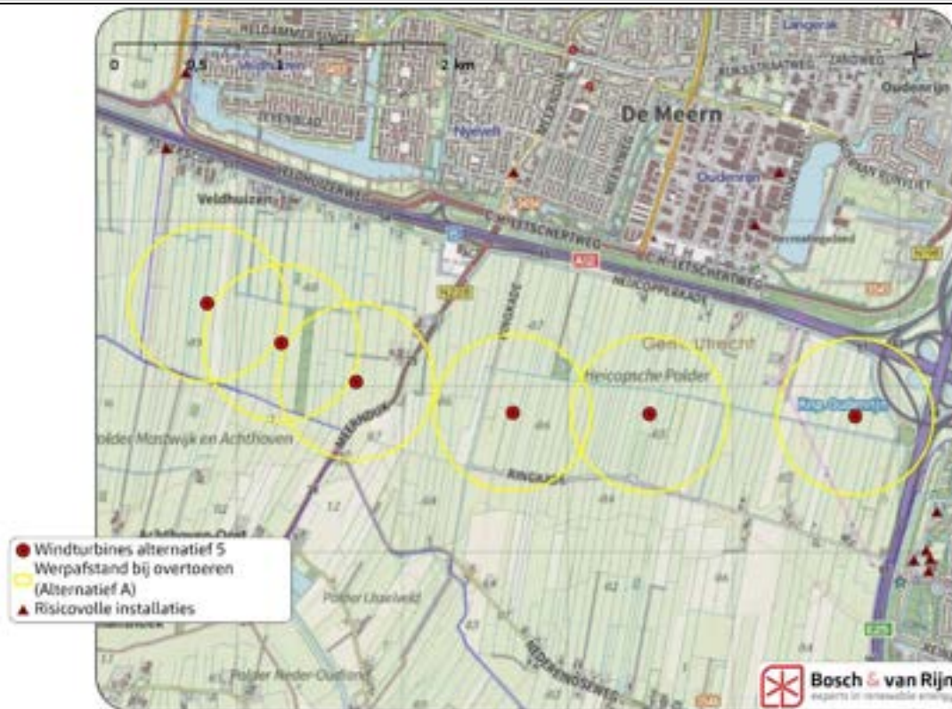
Figuur 20 Maximale werpafstand bij overtoeren van de windturbine en risicovolle installaties
