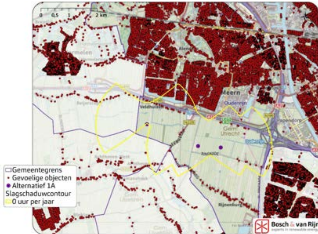
Figuur 9 0 uur slagschaduwcontour van Alternatief 1A. Hierbij zijn ook de gevoelige objecten weergegeven.
