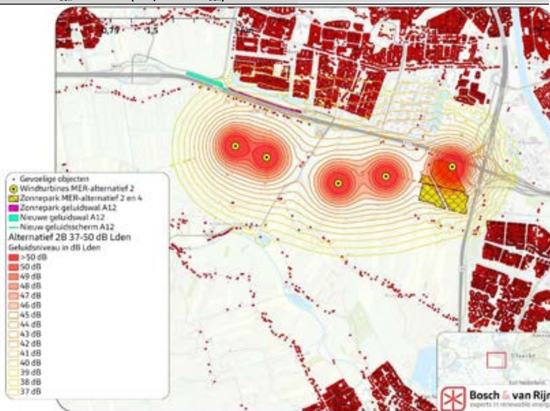
Figuur 92 Lden contouren (37 t/m 50 dB Lden) alternatief 2B
