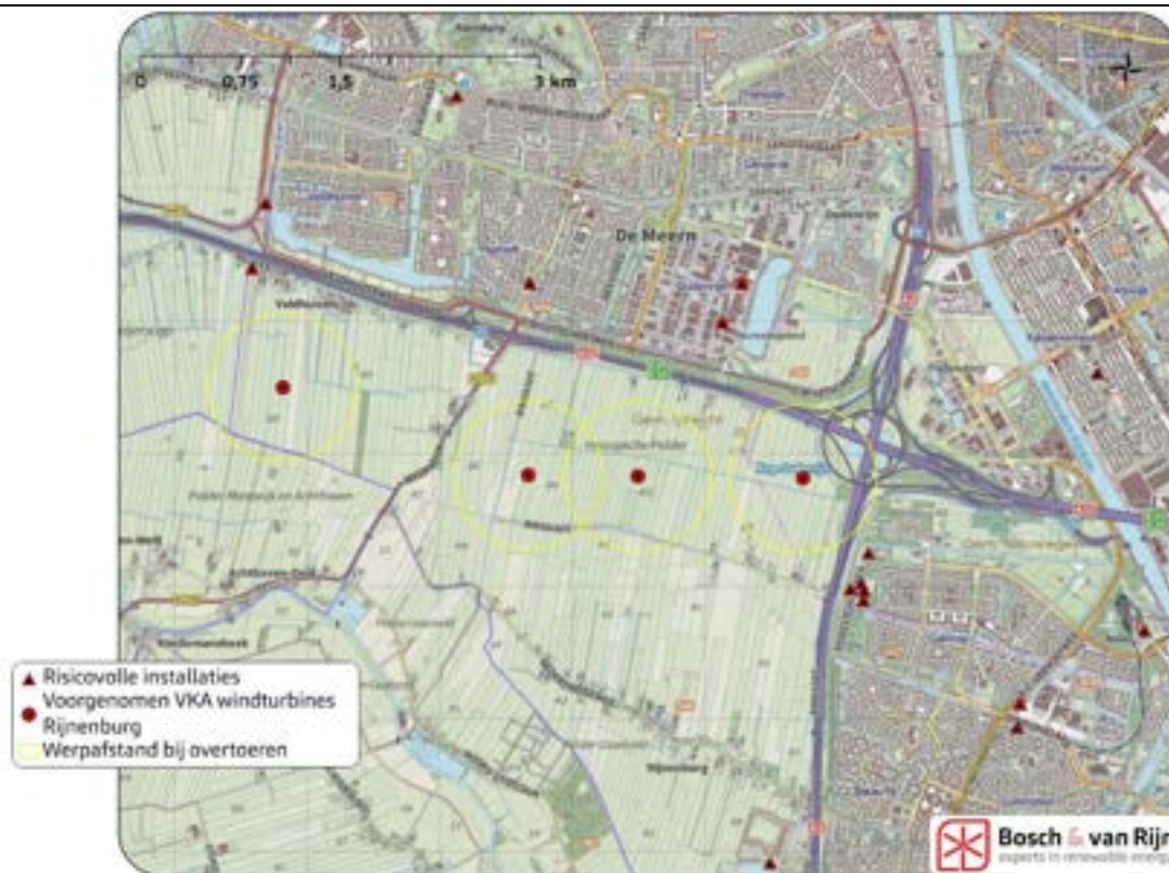
Figuur 62 Ligging van risicovolle installaties binnen de invloedssfeer van de windturbines
