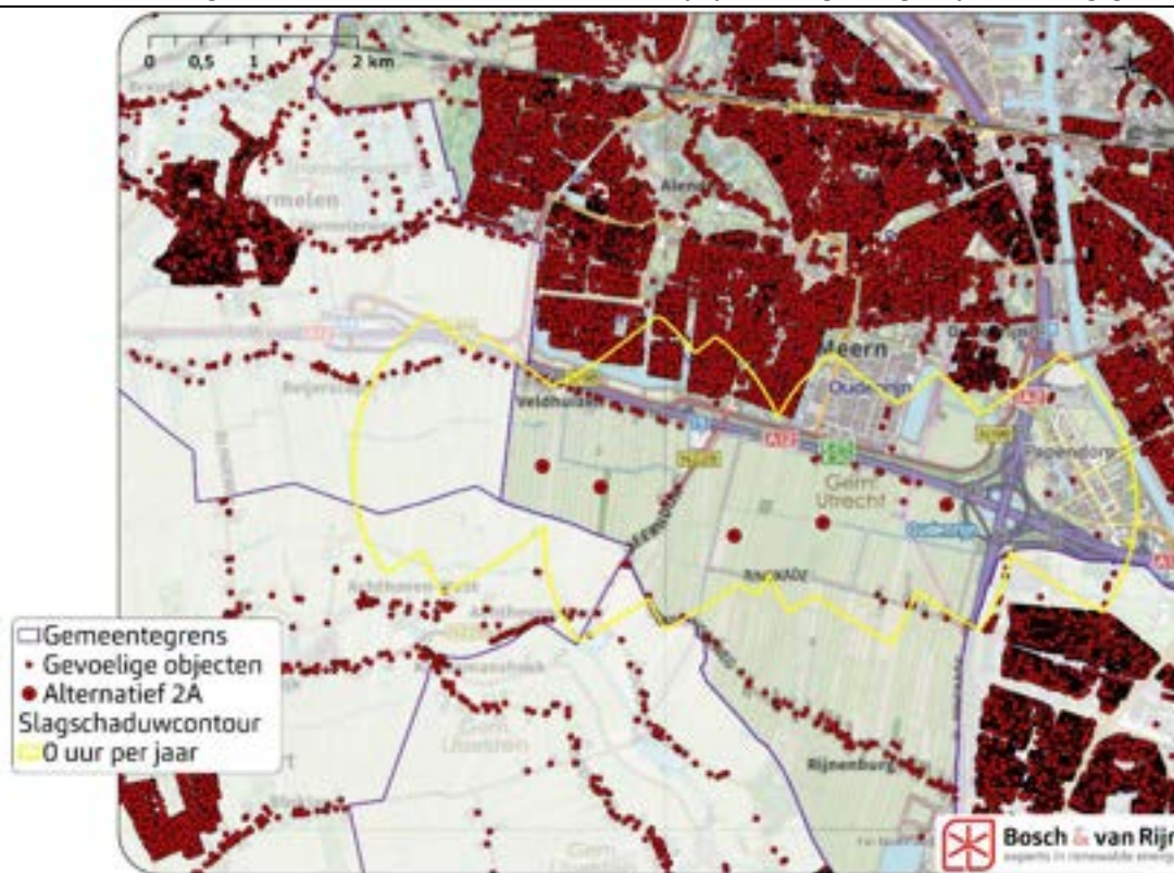
Figuur 11 0 uur slagschaduwcontour van Alternatief 2A. Hierbij zijn ook de gevoelige objecten weergegeven.
