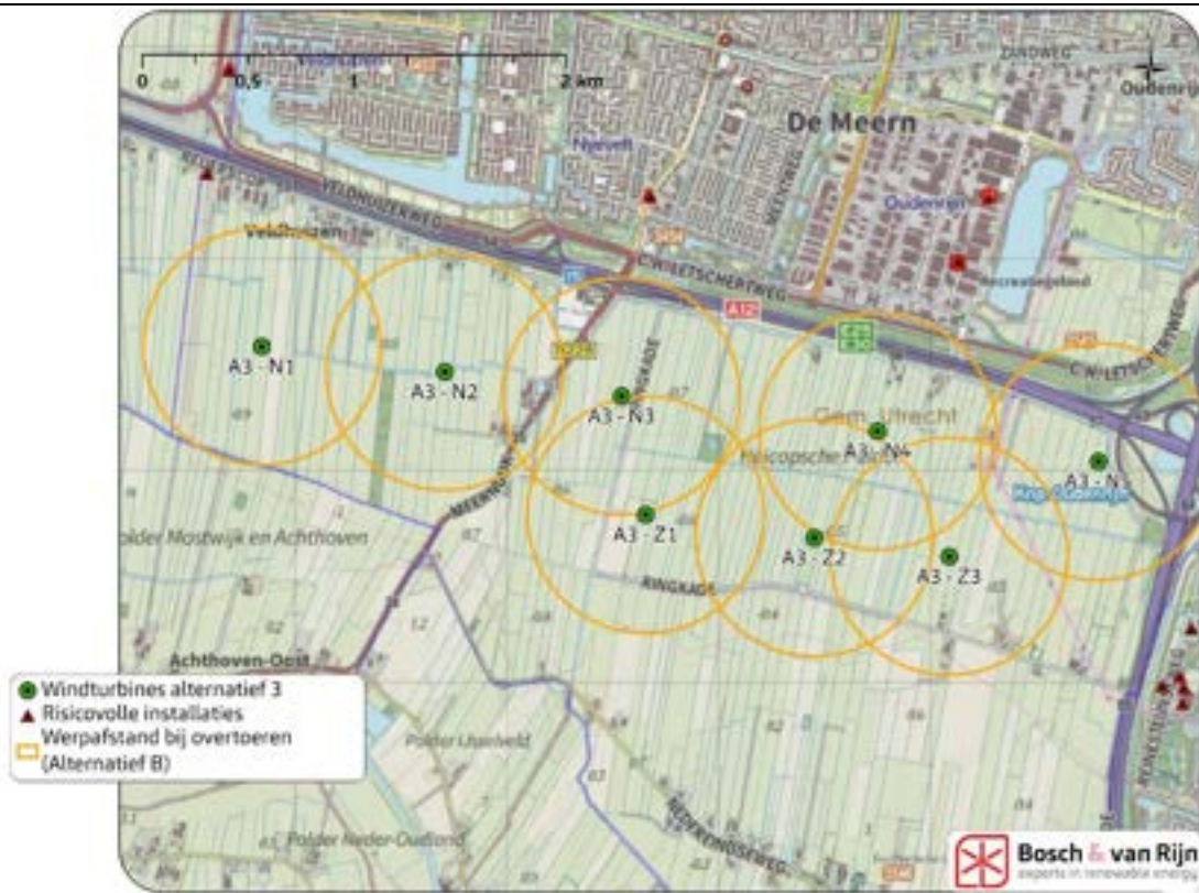
Figuur 17 Maximale werpafstand bij overtoeren van de windturbines en risicovolle installaties.
