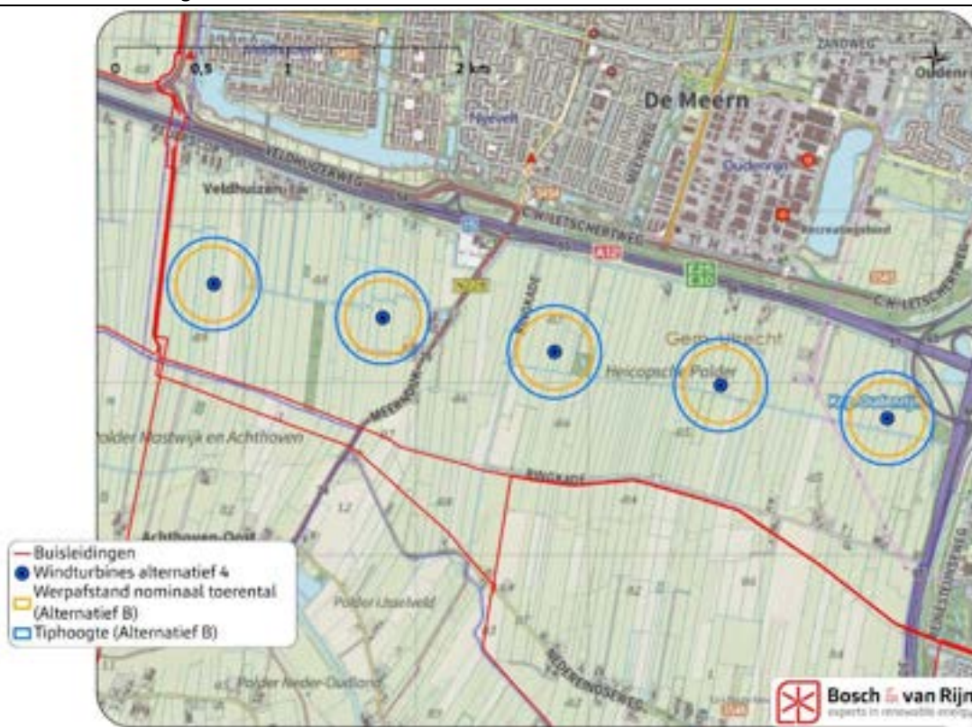
Figuur 29 Buisleidingen en adviesafstanden Gasunie
