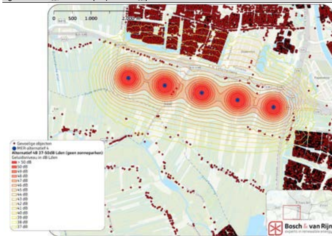
Figuur 33 L den contouren (37 t/m 50 dB L den ) alternatief 4B
