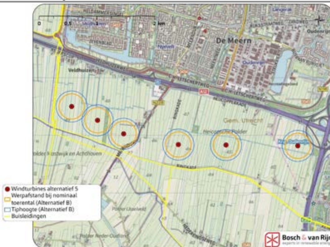
Figuur 31 Buisleidingen en adviesafstanden Gasunie
