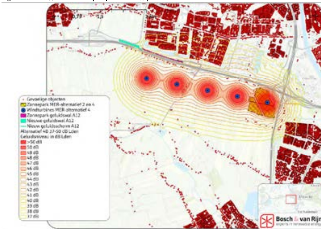
Figuur 28 Lden contouren (37 t/m 50 dB Lden) alternatief 4B
