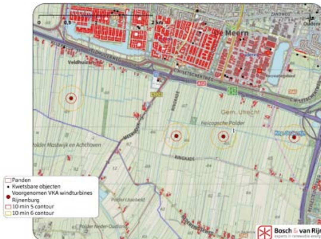
Figuur 24 Risicocontouren rond de windturbines (bovengrens VKA)
