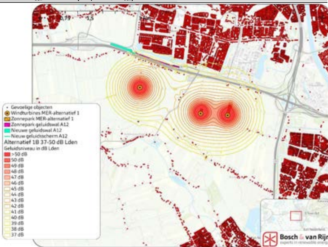
Figuur 90 L den contouren (37 t/m 50 dB L den ) alternatief 1B
