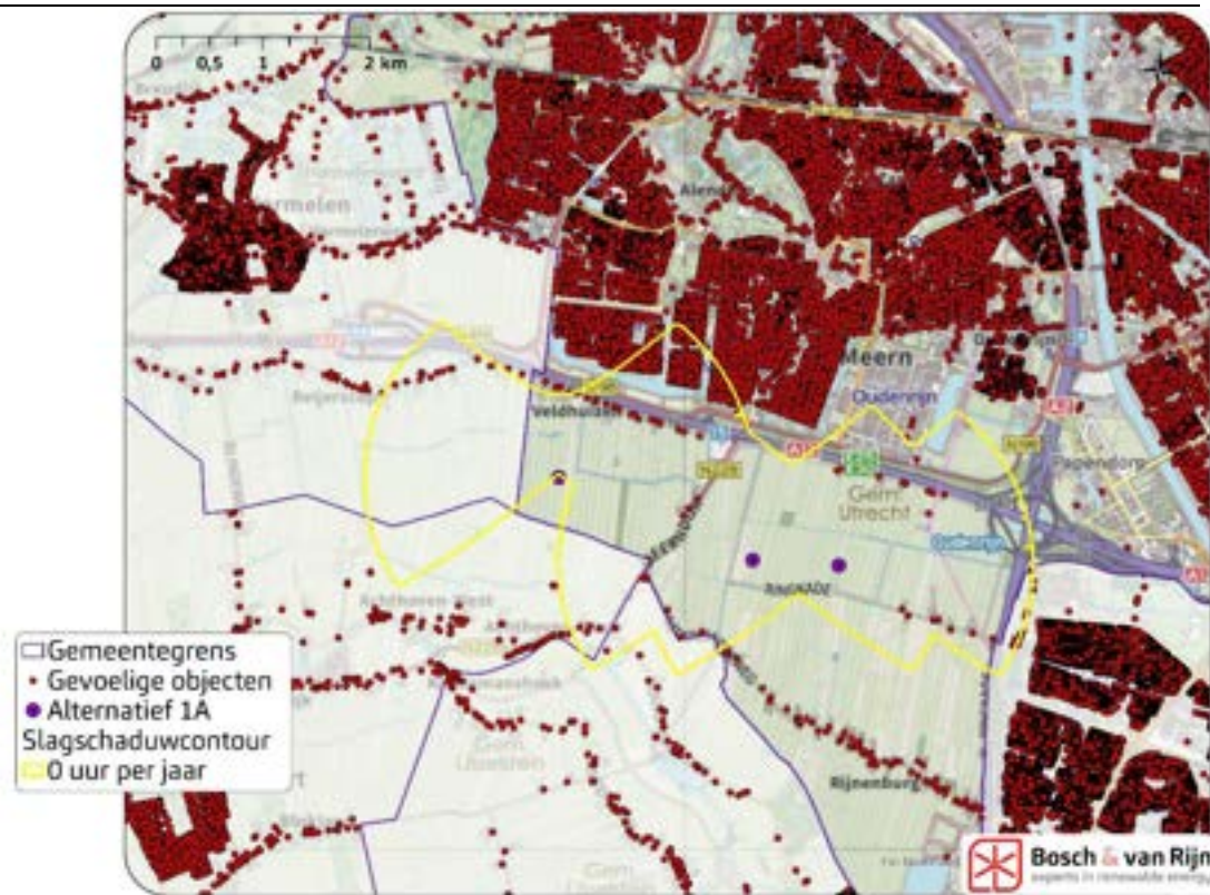
Figuur 37 0 uur slagschaduwcontour van alternatief 1A. Hierbij zijn ook de gevoelige objecten weergegeven.
