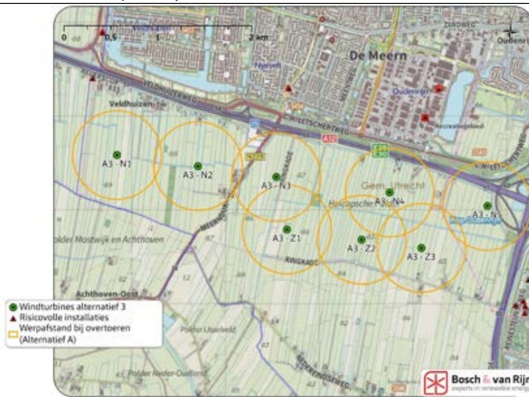
Figuur 16 Maximale werpafstand bij overtoeren van de windturbines en risicovolle installaties.
