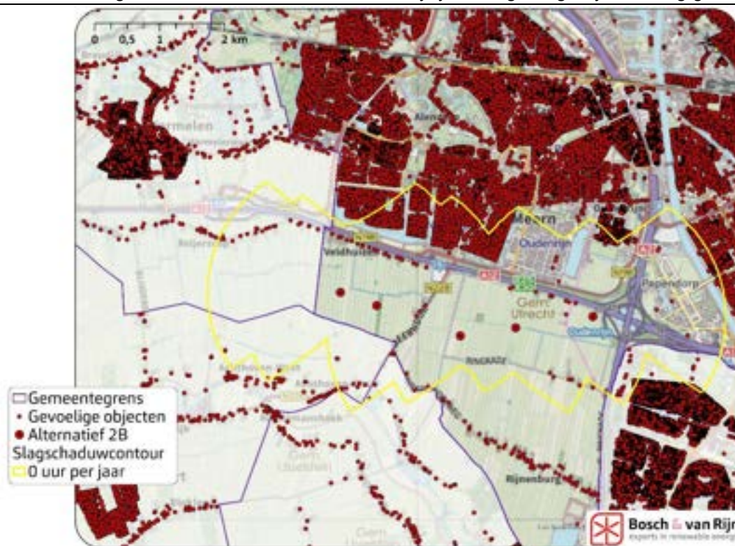
Figuur 12 0 uur slagschaduwcontour van Alternatief 2B. Hierbij zijn ook de gevoelige objecten weergegeven.
