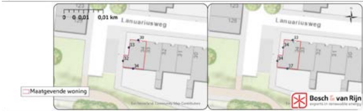
Figuur 51 Geluidsbelasting op de gevels in dB Lden van VKA onder (links) en VKA boven (rechts) - Lanuariusweg 34 De Meern
