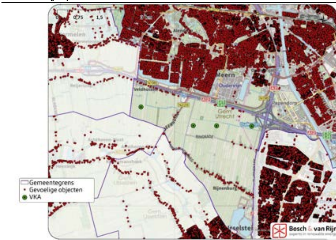
Figuur 19 Windturbinelocaties van het VKA voor Energielandschap Rijnenburg & Reijerscop en geluidsgevoelige objecten.
