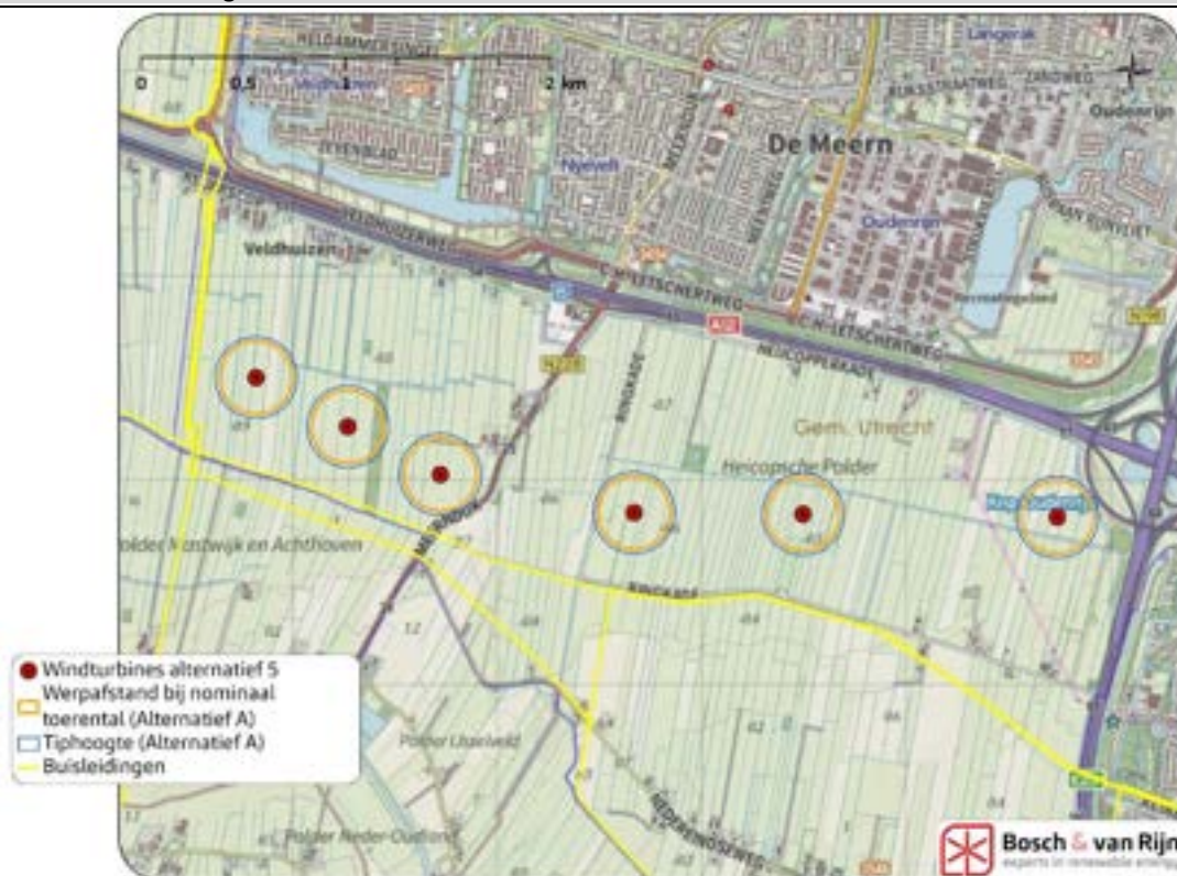
Figuur 30 Buisleidingen en adviesafstanden Gasunie
