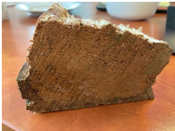
Een stuk hout uit de balanspriem doorgezaagd. De donkere rand aan de buitenkant is zeer waarschijnlijk de beschermlaag die in het hout is getrokken.
