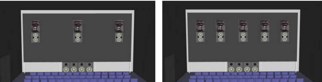
L,M,R geïnstalleerd in een Baffle Wall en het LFE op de vloer
