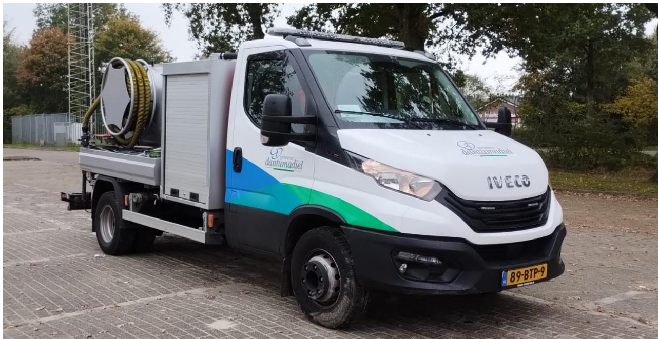
Figuur 4: Compacte riool vacuümwagen met hogedrukhaspel.
