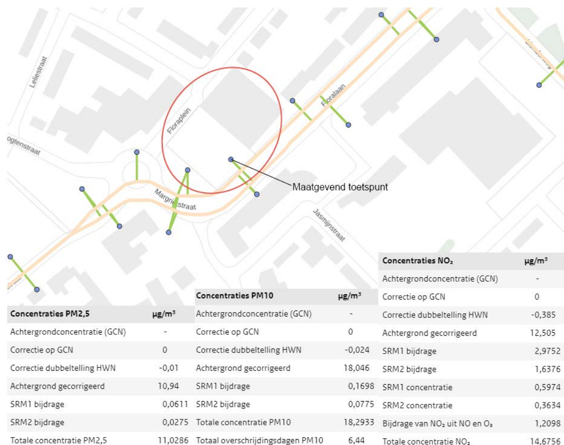
Figuur 4.7 Toetspunt en concentraties \text{NO}_2 , \text{PM}_{10} en \text{PM}_{2,5} Floraplein (Bron: Centraal Instrument Monitoring Luchtkwaliteit)
