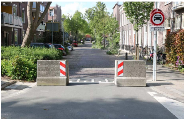
Figuur 5: Voorbeeld palen/betonblokken.
