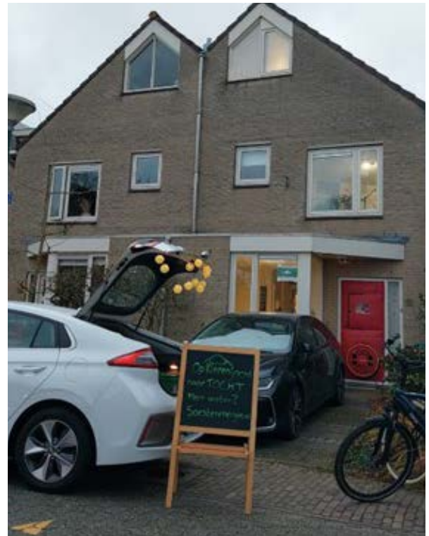
Figuur 21: Woning ondergaat blowerdoortest tijdens 'Kierenjacht' in Overhees
