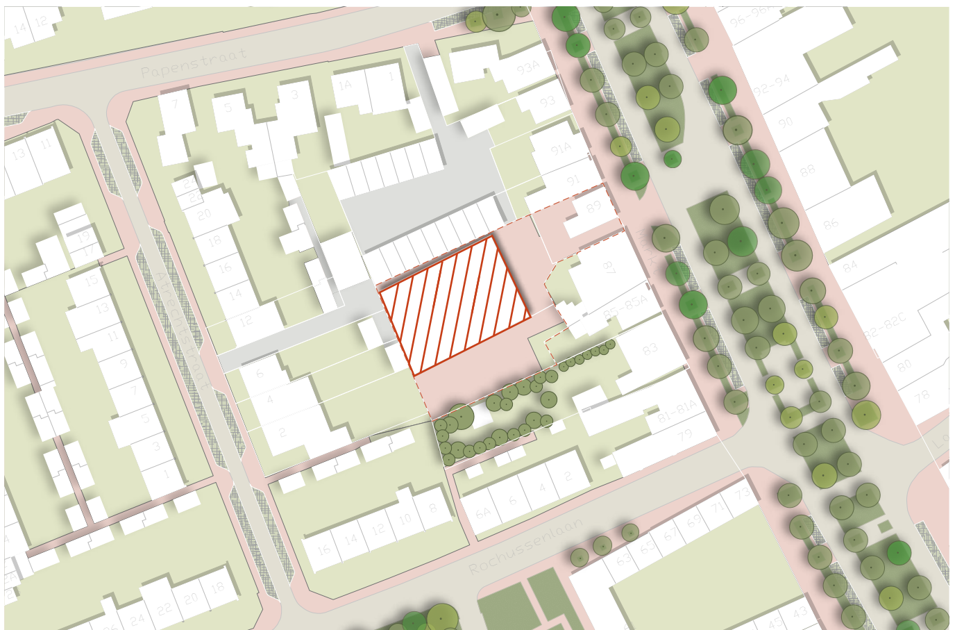
Figuur 2.4: Bestaande situatie, te slopen loods gearceerd
