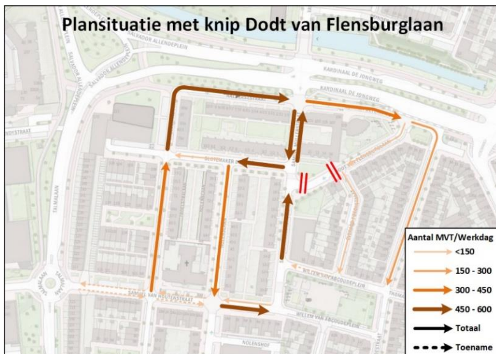
Figuur 4-3 Intensiteiten bij plansituatie met knip Dodt van Flensburglaan
