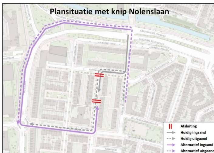
Figuur 4-2 Alternatieve ontsluitingsroutes bij knip Nolenslaan
