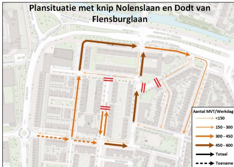
Figuur 4-5 Intensiteiten bij plansituatie met knips op beide locaties
