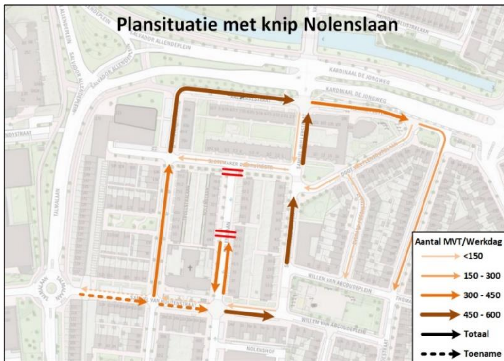
Figuur 4-4 Intensiteiten bij plansituatie met knip Nolenslaan
