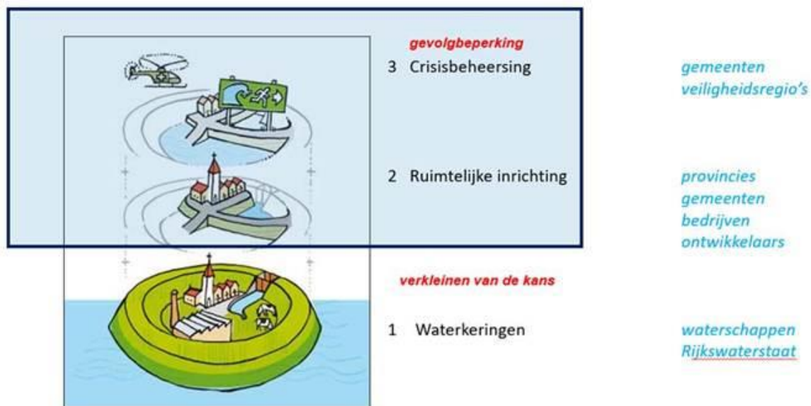
Figuur 4.7 Schematische weergave meerlaagse veiligheidsniveaus Waterveiligheid
