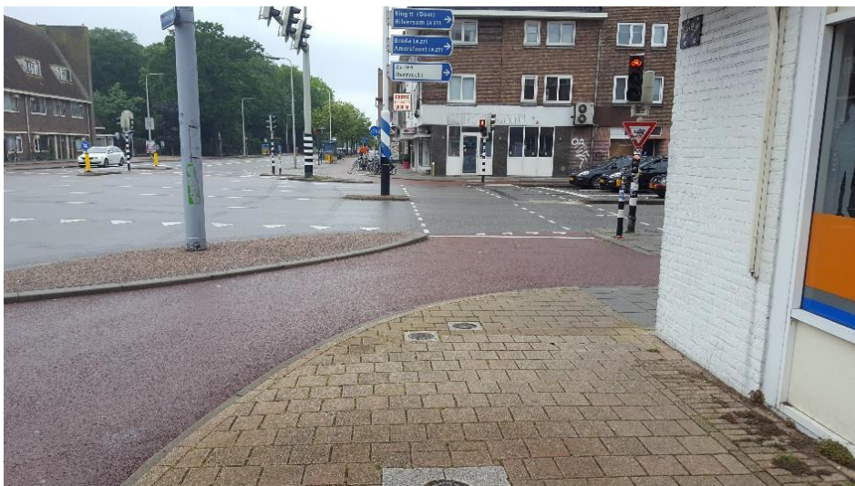
Foto 3: komend vanaf ASW richting kruispunt Marnixlaan-ASW t.h.v. ASW 421. Beperkt zicht op voetgangers om de hoek die fietspad moeten oversteken om overkant ASW te bereiken.
