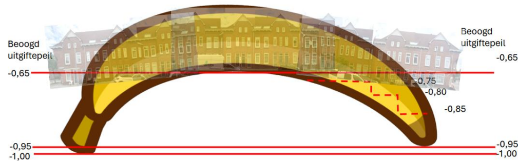
Schematische weergave verzakking Ranonkel en maatwerkoplossing
