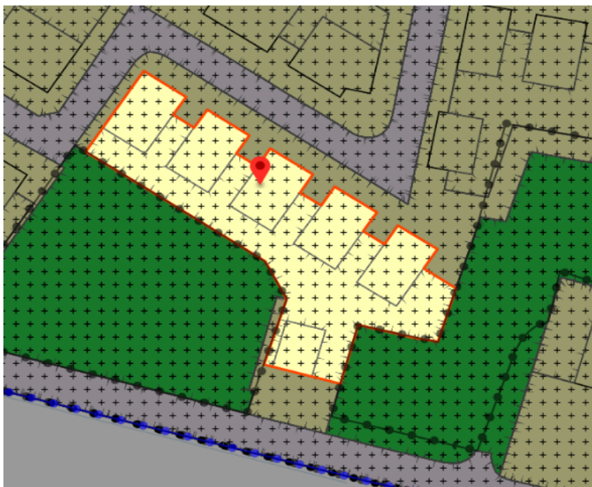
Illustratie 2: Roodomrand is het bouwvlak, overeenkomend met het bebouwingsgebied zoals gehanteerd in de rijksregels voor vergunningvrij bouwen. Het bouwperceel minus het bouwvlak is het voorerf of de voortuin van een woning.
