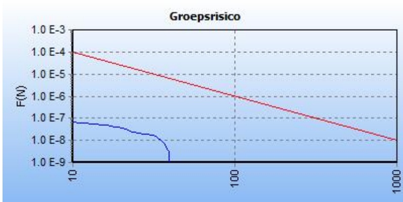
5.2 Figuur 5.2 FN curve voor 7210_leiding-Z-544-01-deel-1 van N.V. Nederlandse Gasunie voor de kilometer tussen stationing 1950.00 en stationing 2950.00
