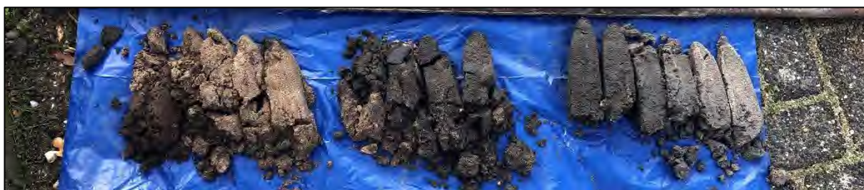
Boring 4: 0-150 cm -Mv. Aanvullende monsternamen van het traject 75-130 cm -Mv.
