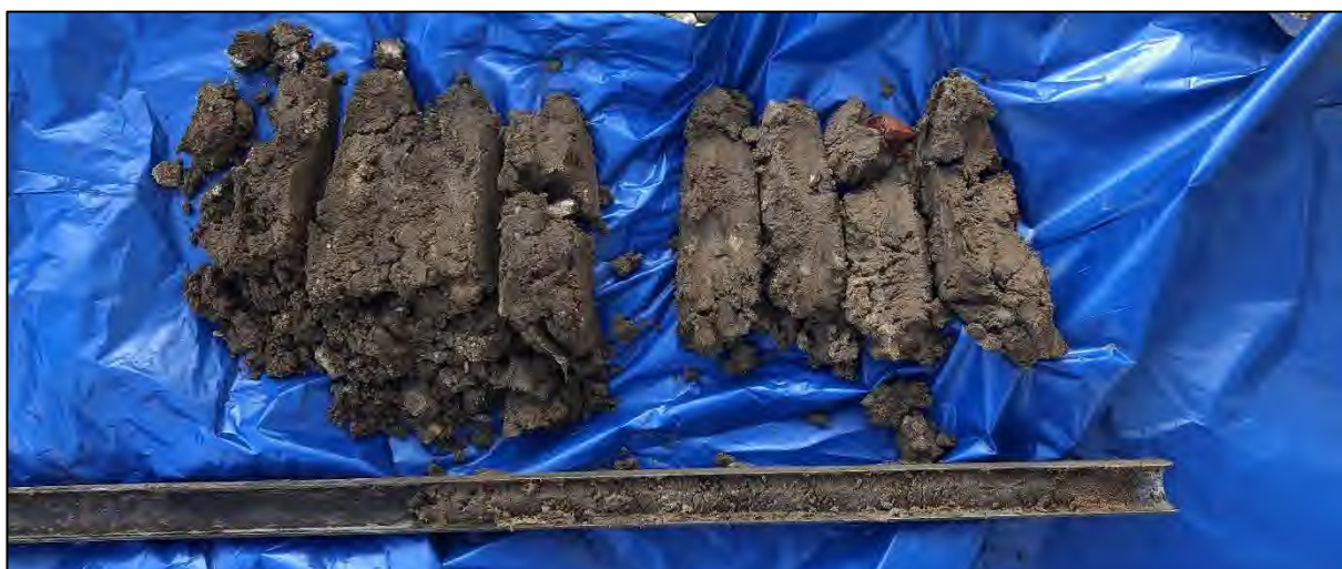
Boring 3: 0-150 cm -Mv. Geboord tot 190 cm -Mv, maar het zand loopt uit de boor door het grondwater.
