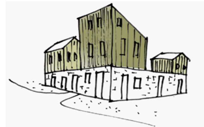
Binnenblok metselwerk plint met houten woningen erboven
