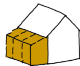
Geluidswering aan de gevel: een serre
