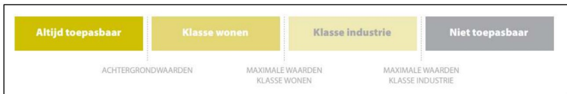
Figuur 1. Generieke normstelling voor het toepassen van grond en baggerspecie op of in de bodem (T1).
