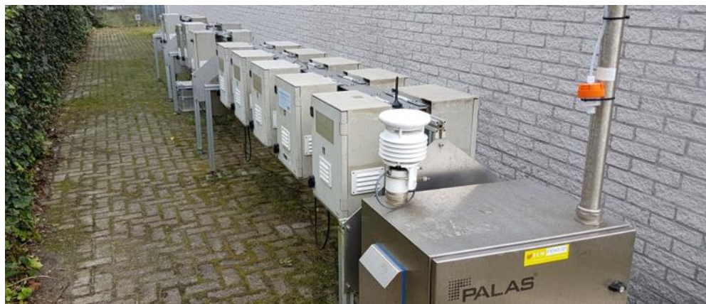
Figuur 2 De kalibratieopstelling van de CAIREBoxen in Alkmaar. De Fidas® 200 S is zichtbaar op de voorgrond.
