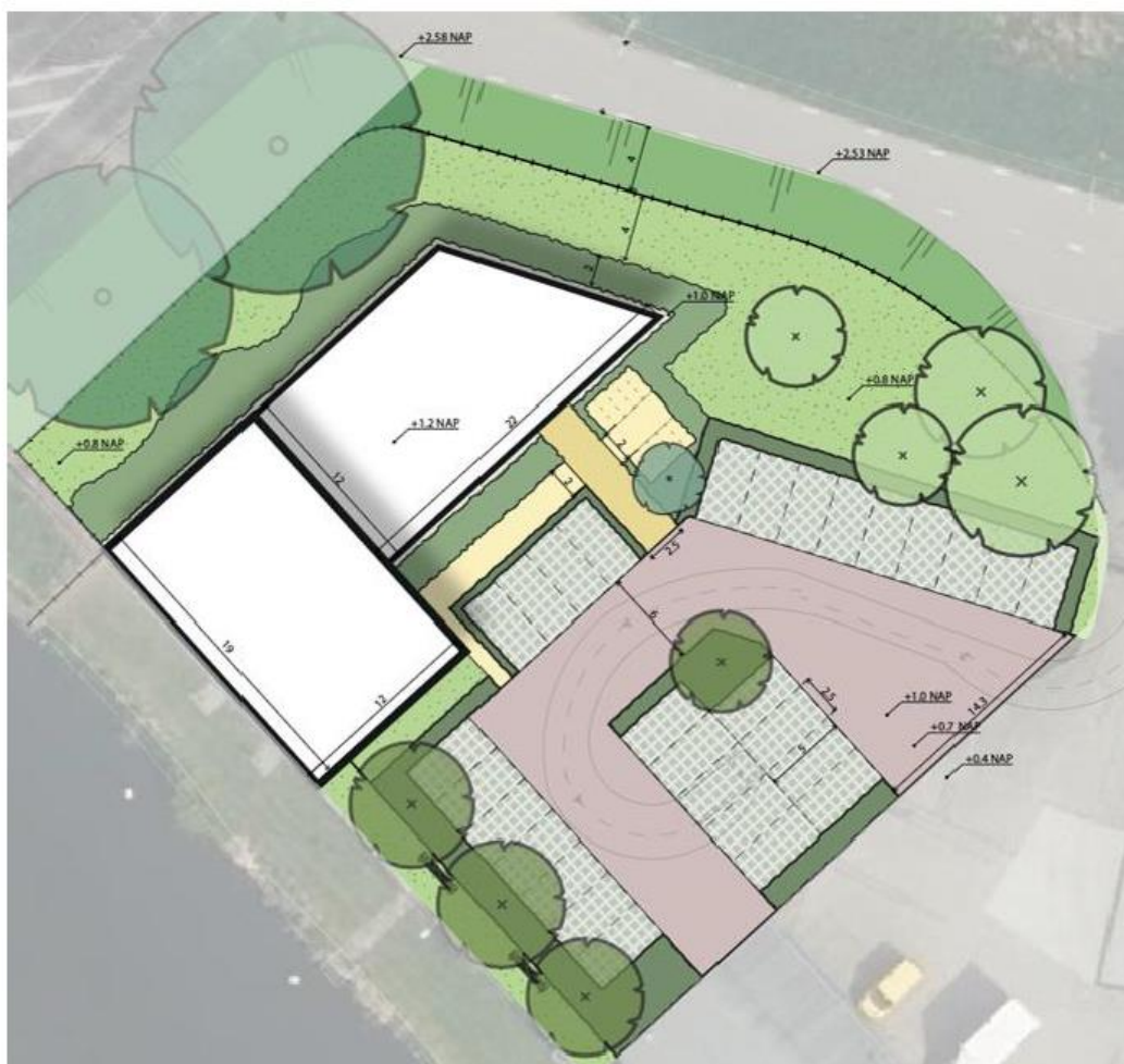
Figuur 5.9 Overzicht toekomstige aanleghoogten terrein (Bron: BOOT)
