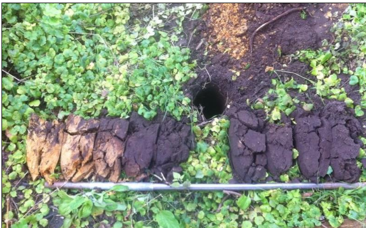
Figuur 4: het profiel van boring 5.
