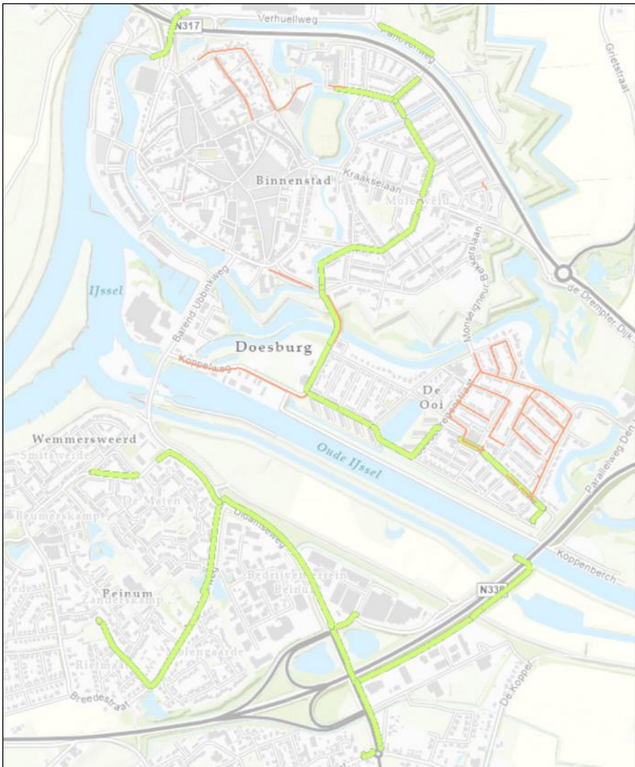
7a: Grijs gietijzeren (oranje) en nodulaire gietijzeren (groen) gasleidingen Doesburg
