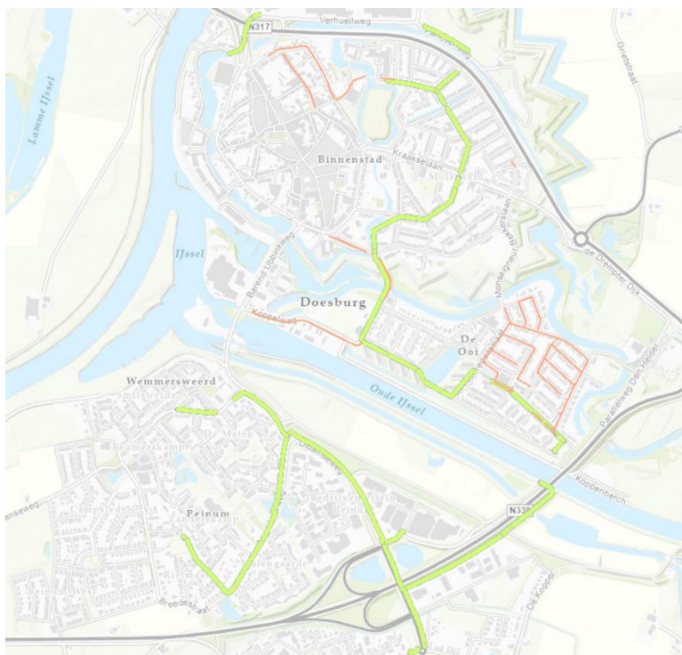
Figuur 1. Grijs gas (oranje) en nodulaire gas (groen) gasleidingen Doesburg.
