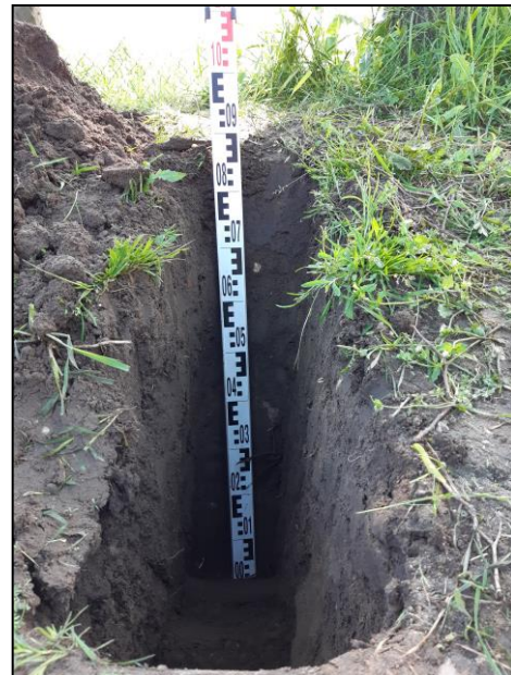
Figuur 8: Opname bodemprofiel aan de rand van het wegdek ter plaatse van boom 1.
