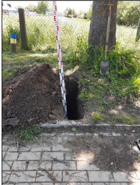
Figuur 8: Opname bodemprofiel aan de rand van het wegdek ter plaatse van boom 1.
