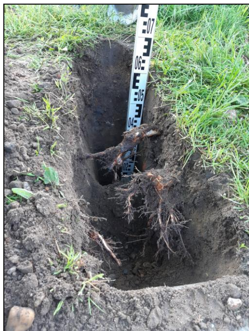
Figuur 6: Opname bodemprofiel aan de rand van het wegdek ter plaatse van boom 6. Foto links wortelstompen nabij de rijbaan.
