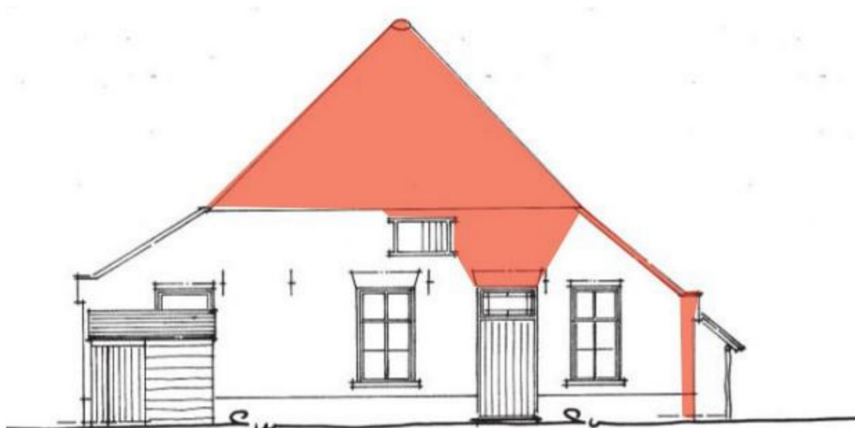
Figuur 6 - Achtergevel zoals die oorspronkelijk was. In rood het gedeelte dat inmiddels is ingestort. Het betreft het dak en het gedeelte van het muurwerk boven de deur, inclusief hanenkam (opmetingstekening Van Hooft Architecten, 2008).
