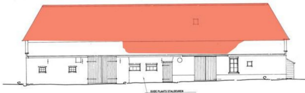
Figuur 8 - De rechter zijgevel zoals die oorspronkelijk was. In rood het gedeelte dat inmiddels is ingestort. Het betreft een groot deel van het dak (opmetingstekening Van Hooft Architecten, 2008).
