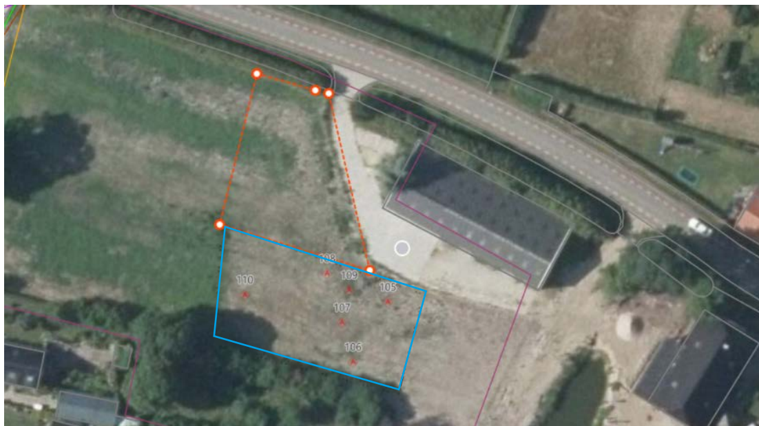
Figuur 4.1 Asbestverdacht materiaal binnen de onderzoekslocatie (weergegeven binnen de blauwe contour als nummer 105 tot en met 110) en buiten de onderzoekslocatie (binnen de oranje contour)
