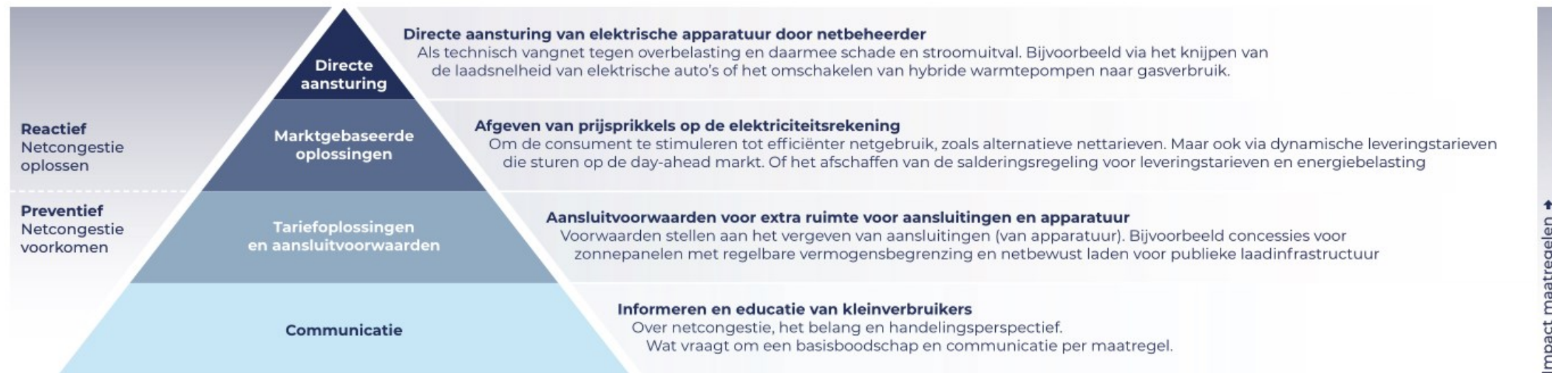
Figuur 16 Maatregelenladder voor het efficiënter benutten van het net, opgemaakt op basis van de Actieagenda netcongestie laagspanningsnetten. Hoger in de piramide worden maatregelen ingrijpender voor de consument.
