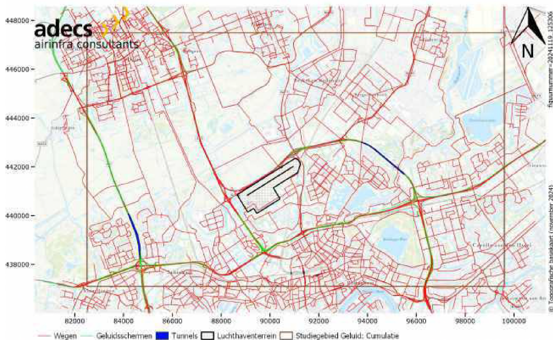
Figuur 23 Overzicht van de invoergegevens voor wegverkeersgeluid met de ligging van de wegen, geluidsschermen en tunnels en de grens van het studiegebied.
