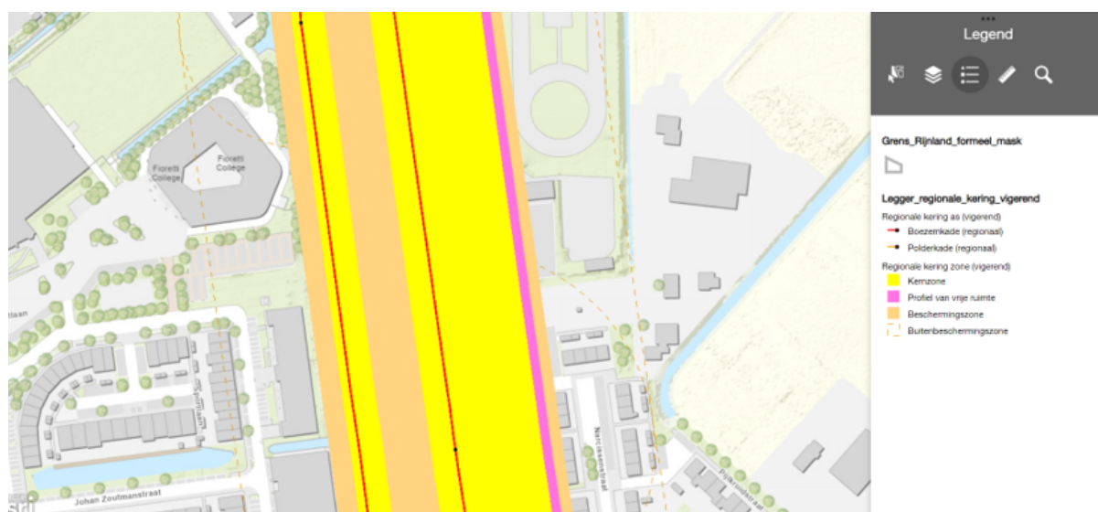
Figuur 5-12: Ligging van de keringen en bijbehorende beschermingszone's langs de Ringvaart. Screenshot uit de legger van het Hoogheemraadschap van Rijnland
