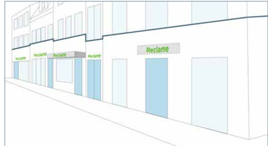
1. Plat tegen het gevelvlak
