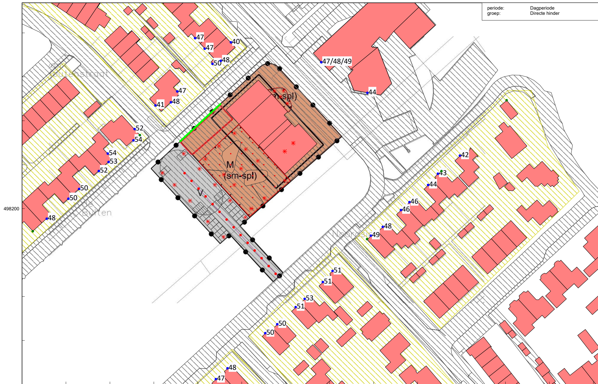
Figuur 2 Optredende langtijdgemiddelde beoordelingsniveaus in de dagperiode op begane grond woningen met een berging/fietsenstalling met een hoogte van 2,5 meter aan de noordwestzijde van het terrein Achterwand volledig gesloten, naad- en kierdicht
