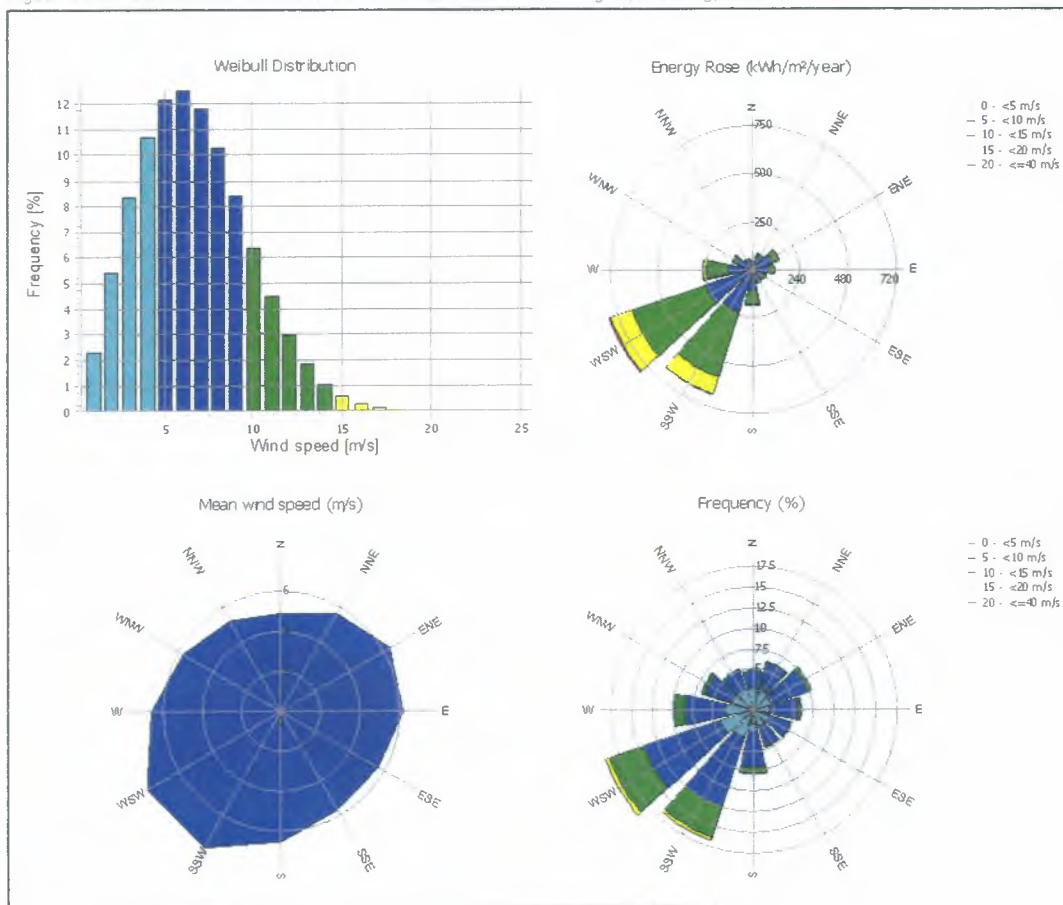
Figuur 2.2 Karakteristieken oxaal Windklimaat op 160.3 meter hoogte (Wienwegplateau)
