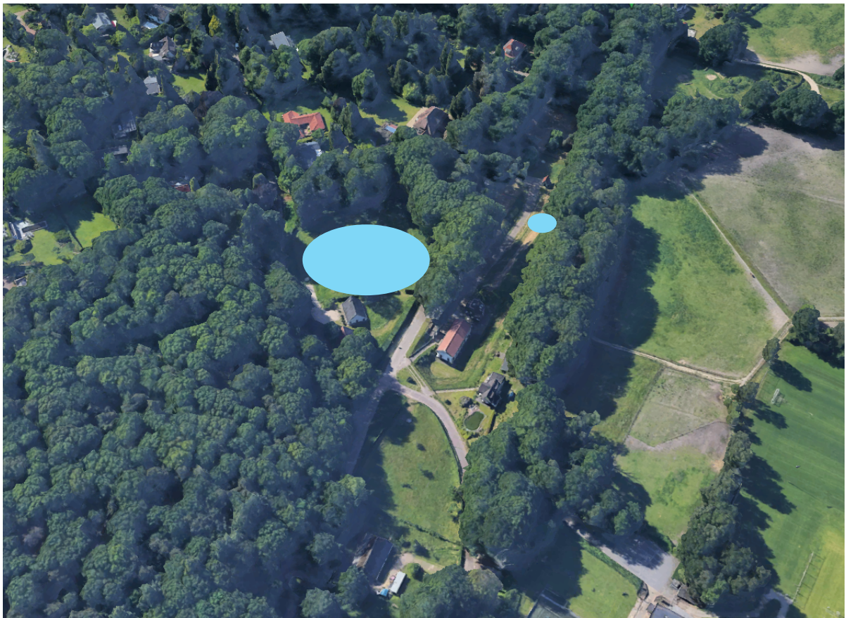
Luchtfoto van het waterpompstations-complex Pinkenberg met blauw omcirkeld de locatie waar Vitens de nieuwbouw wil realiseren. In het klein (rechts) de locatie voor de spoelwaterinstallatie (diameter á 15m, hoogte 1,5m).
