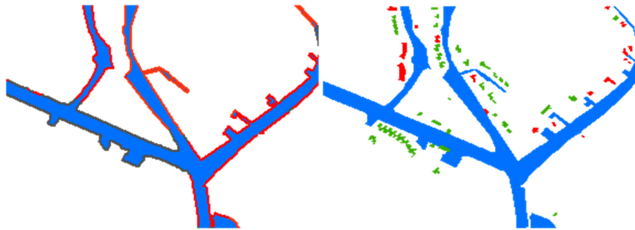
Figuur 3-4. Uitsnede van de resultaten van de analyse van de schade aan boezemkaden en boezemland, in rood is de beschadigde oever (links) en de beschadigde woningen (rechts) weergegeven. Grijs en groen gearceerde oever c.q. woningen worden niet beschadigd
