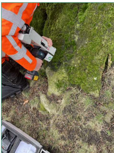
Afbeelding 3.6; Meting met Resistograaf
