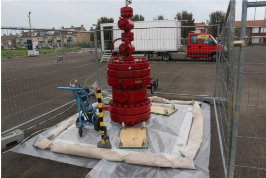
Figuur 1 Opzet van het experiment, op de voorgrond de afgedekte putkelder, blauw de lachgasrelease en op de achtergrond de meetwagen met de instrumenten.
