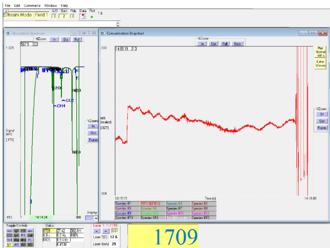
Figuur 16 Screenshot: Meting aan buitenlucht, ook sinus zichtbaar en een stijging van C_2H_6 (Figuur 15).
