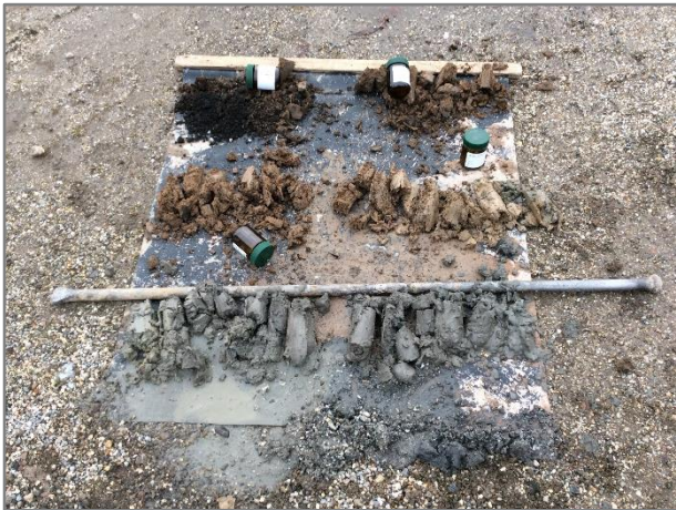
Foto 1: Bodemopbouw boring 31, donkergekleurde puinlaag
