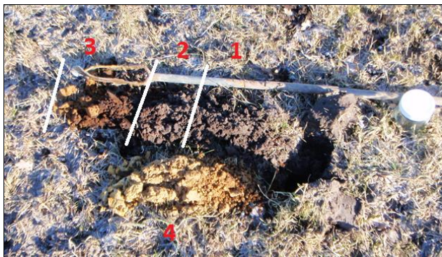
Afbeelding 15. Foto van boring 19, waarbij: 1: bouwvoor, 2: E-horizont, 3: B-horizont, 4: C-horizont
