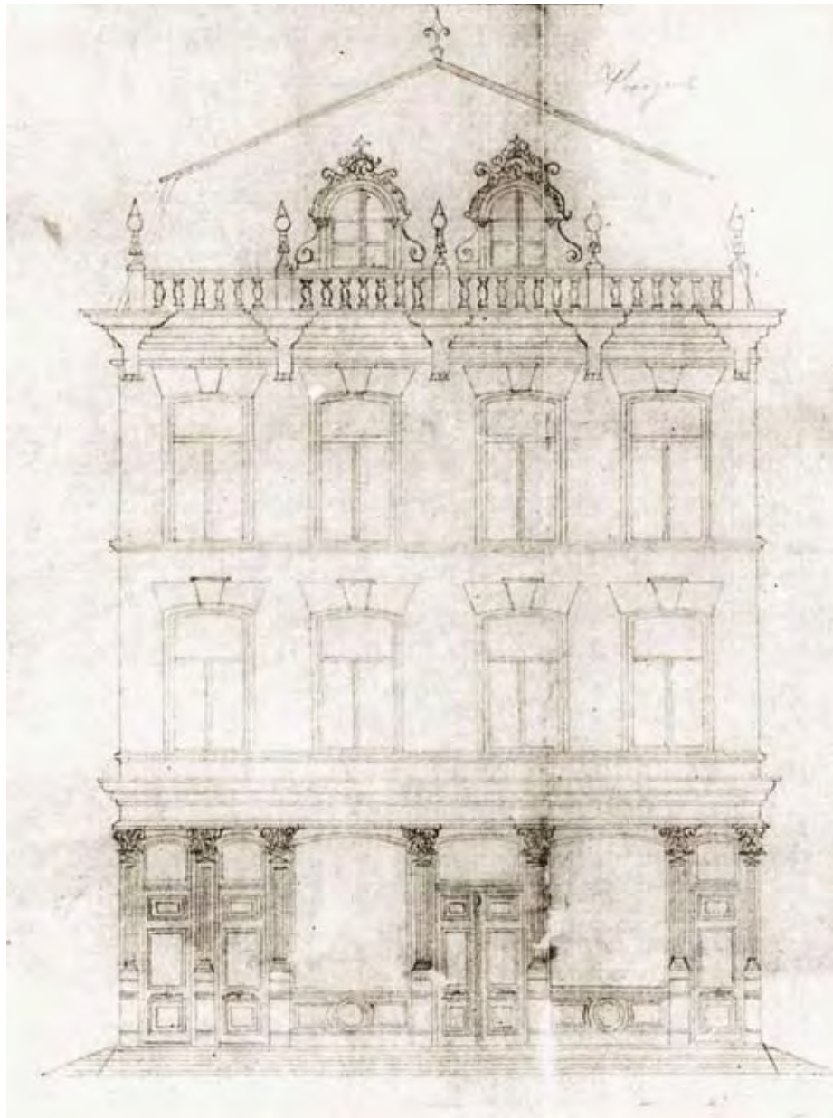
Afb. 29: Ontwerp voor de voorgevel van Toussaintkade 15-19 door P.J. Hoeks jr. Het ontwerp is typerend voor de hand van een meestertimmerman, de maatverhoudingen zijn niet geheel correct en ornamentiek is overdreven groot getekend. De rijk versierde dakkapellen zijn later verdwenen
