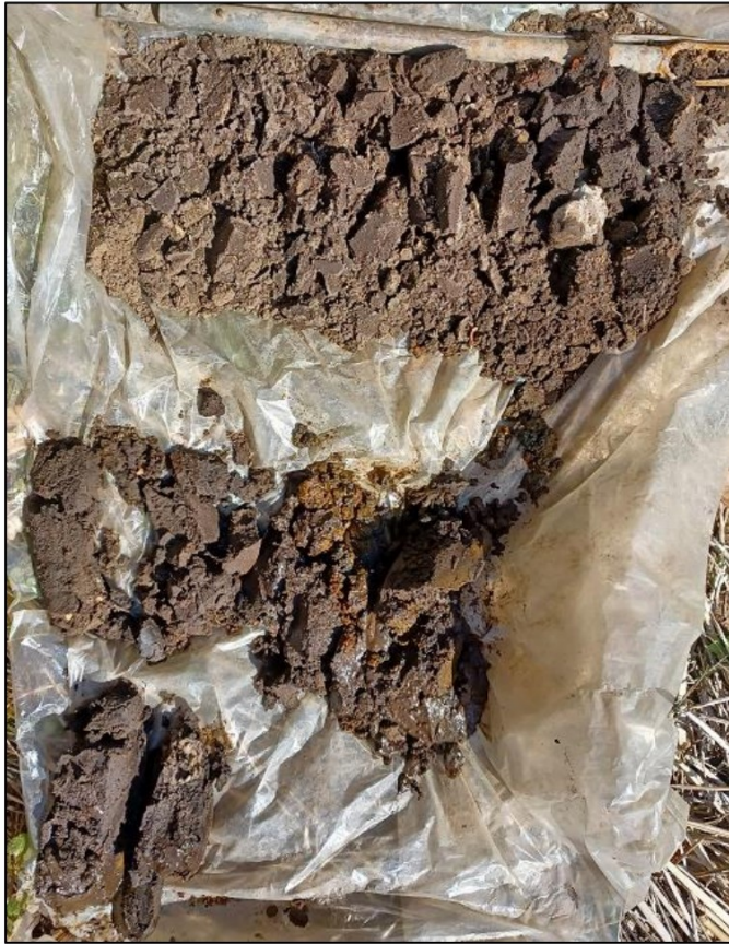
Figuur 11. Boorprofiel boring 5 deel 2. Leesrichting van linksboven naar rechtsonder. 100 tot 210 centimeter -mv.
