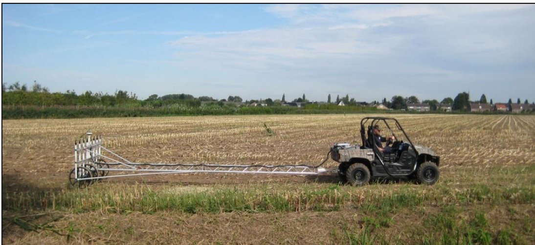
Afb.1 - Multisensorsysteem door een voertuig voortgetrokken.
