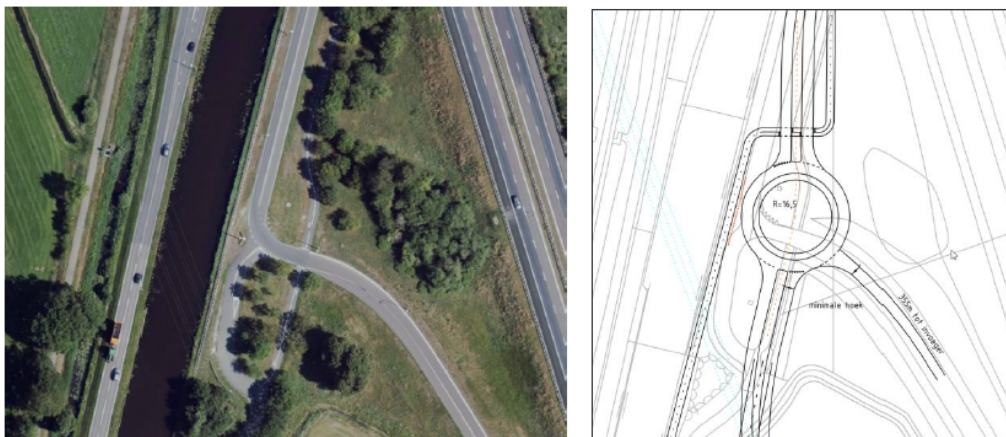
Figuur 2.5: Vormgeving kruispunt toerit A32-zuid, huidig (links) en schetsontwerp toekomst (rechts)
