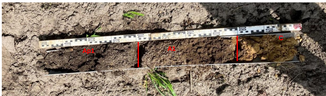
Afbeelding 14: Boring 10 met van links naar rechts de bouwvoor (Ap1), plaggendek (A1) en het dekzand (C).
