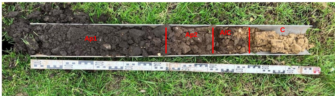
Afbeelding 13: Boring 3 met van links naar rechts de bouwvoor (Ap1), (sub)recente verstoring (Ap2), menglaag (A/C) en het dekzand (C).
