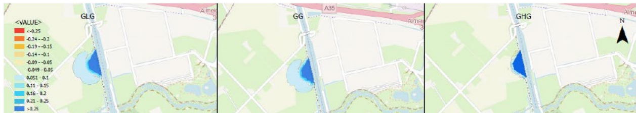
Figuur 2-7 Uitsnede verwachte grondwatereffecten ter plaatse van de zwaaiikom, afkomstig uit rapport Analyse grondwatereffecten gebruikersfase.
