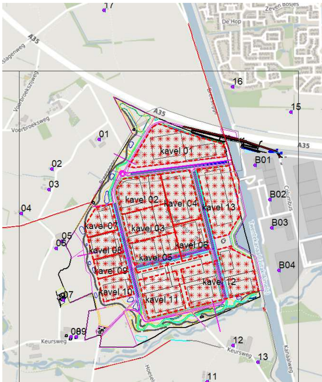
figuur 5: overzicht van het rekenmodel voor de cumulatieve geurberekening naar de omgeving, met rekenpunten op de omliggende gevoelige gebouwen (punt 0-17 (bedrijfs)woningen) en bedrijfsgebouwen (B01-B04).
