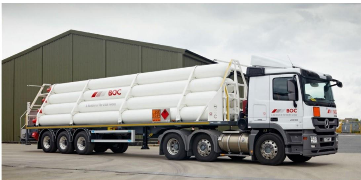
Een tube-trailer met 9 stalen drukcilinders ( 200 bar ) (M-Tech, 2020)
