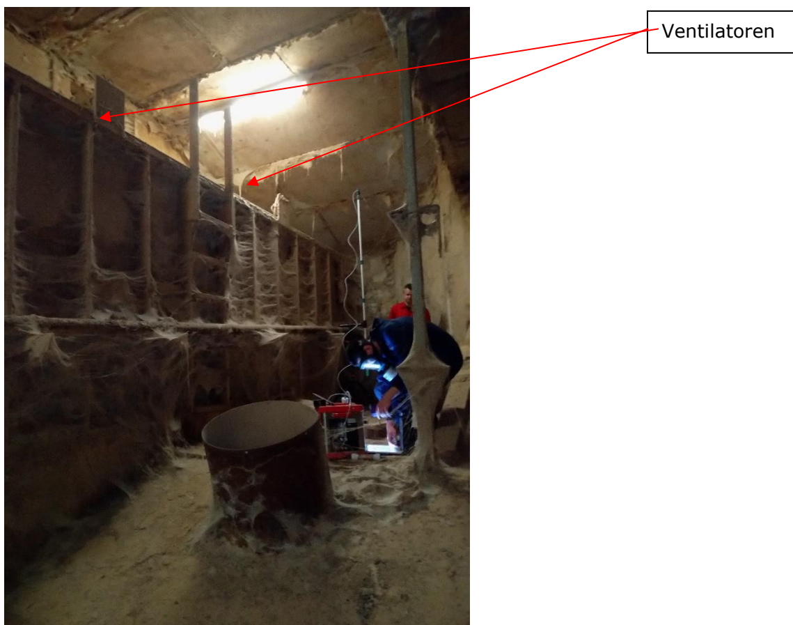
Figuur 2.2 Foto van de meetsituatie van de ongereinigde afgasstroom Wasser Biggenstal.
