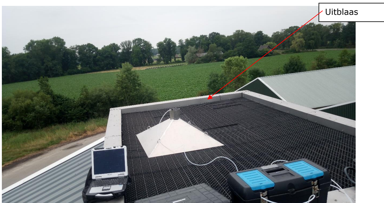
Figuur 2.3 Foto van de meetsituatie van gereinigde afgasstroom Wasser Biggenstal
