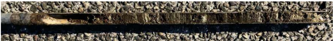
Figuur 13: Oranjewoud, Oranje Nassaulaan 12: Boring 1, diepte 140-190. De dunne lagen veen, zand en klei.
