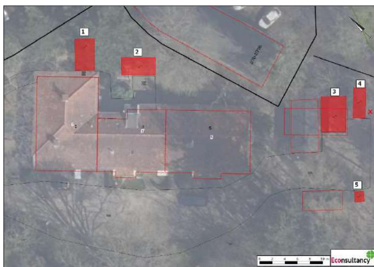
Figuur 9.1 Asbestverdachte daken (nr. 1 t/m 5).
