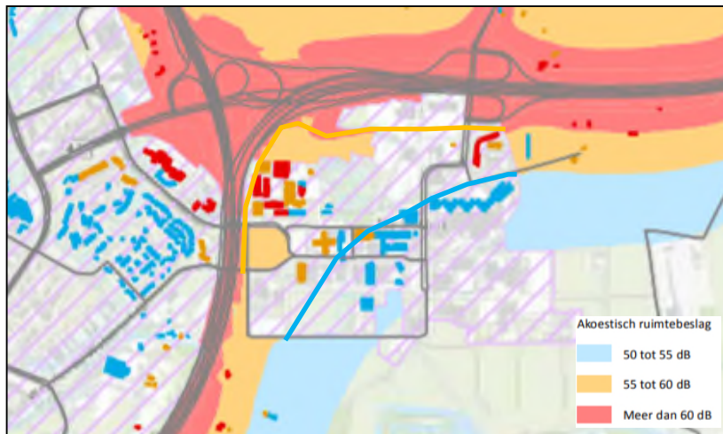
Figuur 6-3: Geluidbelasting snelwegen in plansituatie (Bron: Ontwerp-Tracébesluit 2020).
