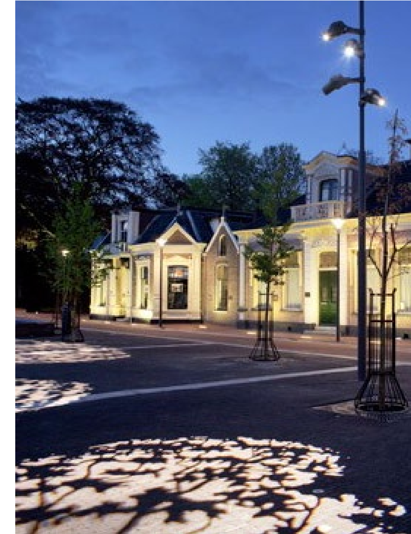
Gobo met opzetstuk filter met patroon
